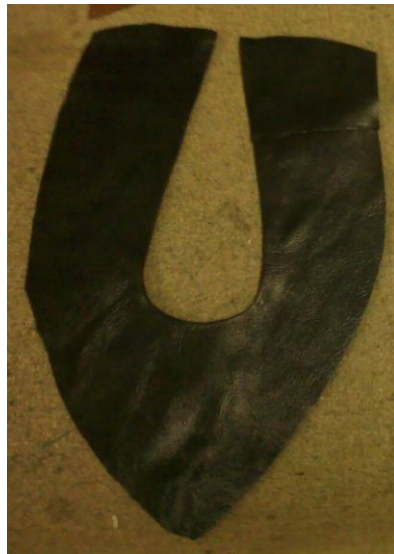
Figura 77 - Corte e costura do cabedal.
