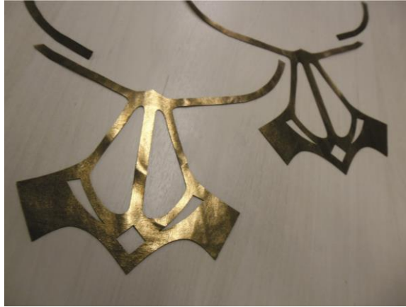
Figura 76 - Corte a laser da peça que sobrepõe o cabedal.
