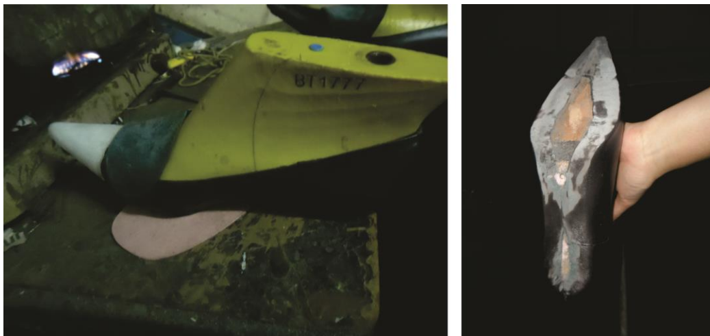
Figura 79 - Colagem da couraça e acabamento do cabedal.
