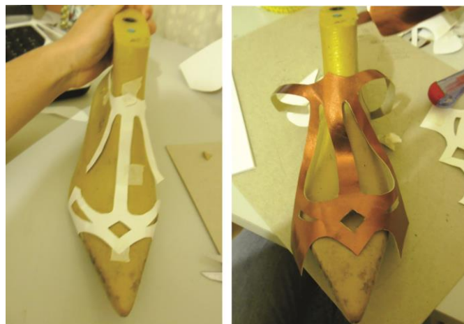
Figura 71 - Testes da planificação da sobreposição do cabedal.
