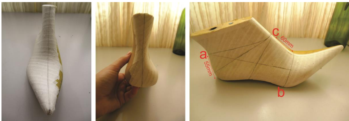
Figura 61 - Linhas e pontos importantes para o conforto do calçado.
