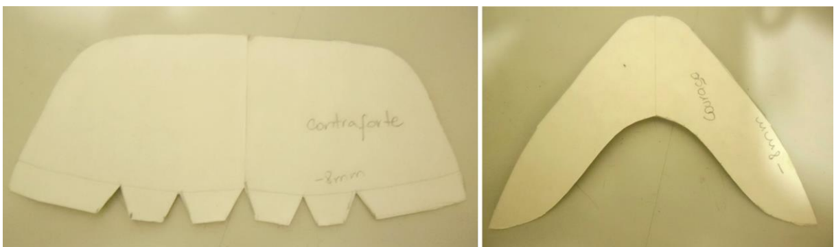
Figura 74 - Respectivamente, modelagem do contraforte e da couraça.
