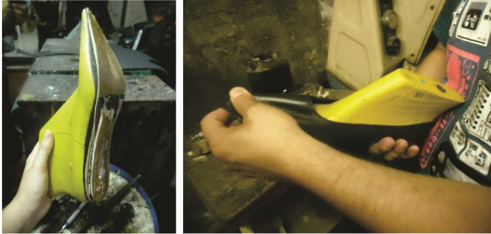
Figura 78 - Conformação da palmilha e cabedal sobre a forma.
