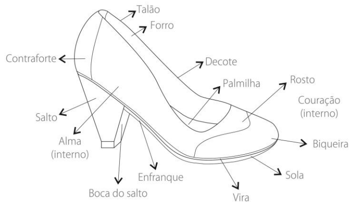
Figura 25 - Estrutura do calçado, adaptado de O'keeffe, 1996.
