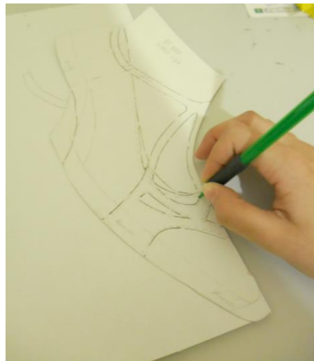
Figura 70 - Planificação da sobreposição do cabedal com pontos de rotação.
