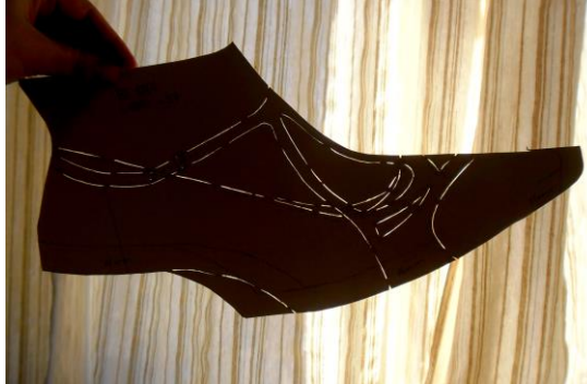
Figura 68 - Vincos da linhas principais do Corpo de Forma.
