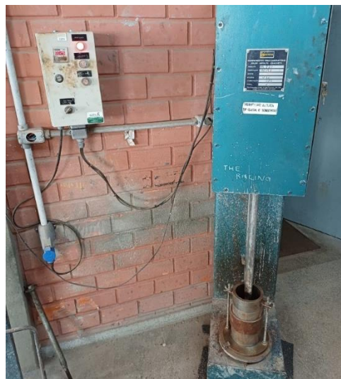
Figura 7 - Ensaio de compactação com compactador mecânico
