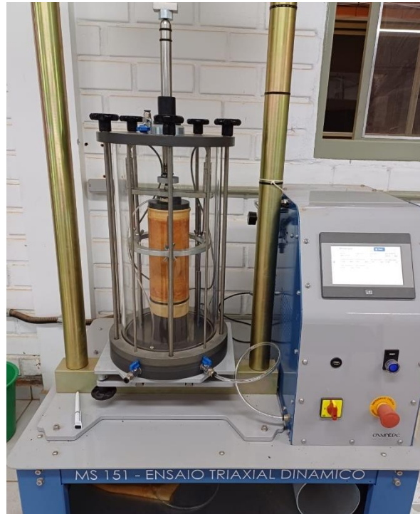
Figura 9 - Amostra posicionada no equipamento triaxial de cargas repetidas
