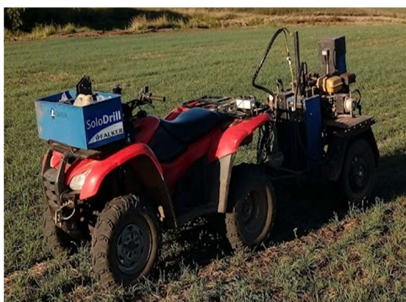
Figura 4: Equipamento utilizado para as coletas de solo, coletor de solo com broca da marca Falker rebocado por quadriciclo.
