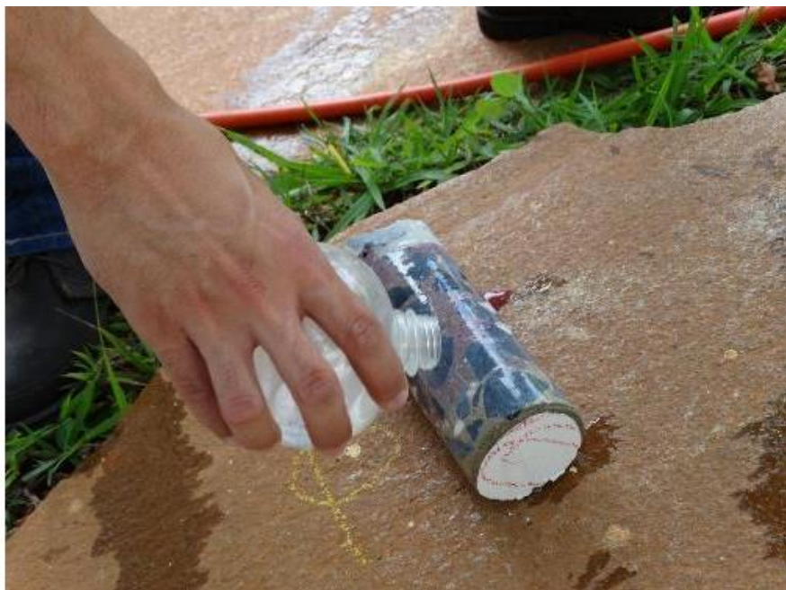
Figura 38 - Aplicação de fenolftaleína em testemunhos
