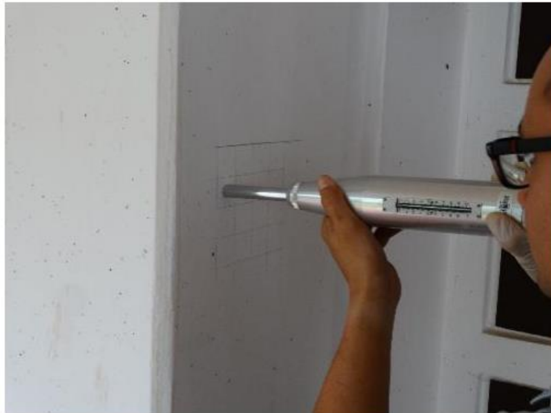
Figura 17 - Realização de ensaio de esclerometria em Pilar de Concreto Armado
