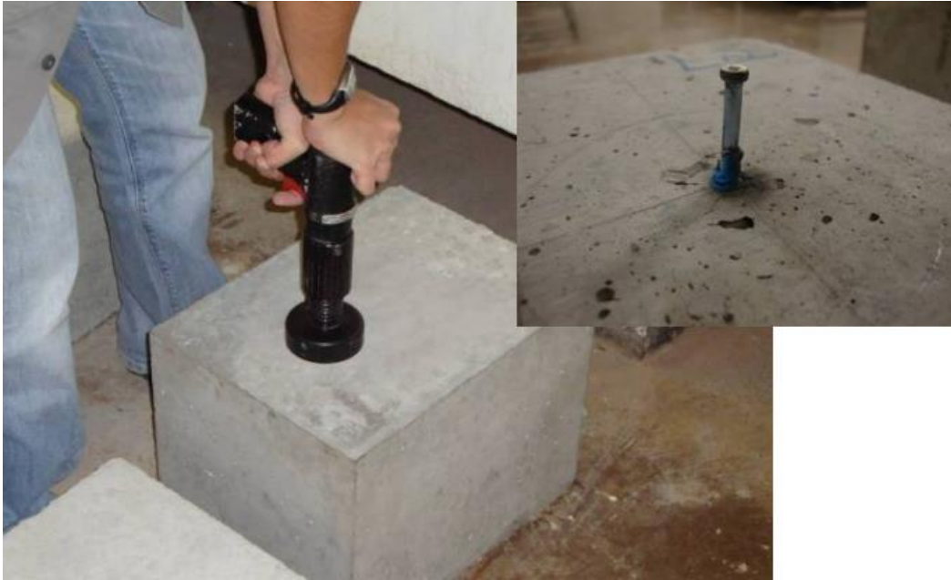
Figura 27 - Execução do ensaio de penetração de pino
