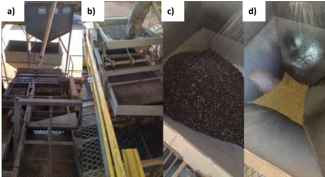
Figura 24 – a) lavador; b) lavador recebendo o café; c) café boia separado e d) café cereja descascado.
