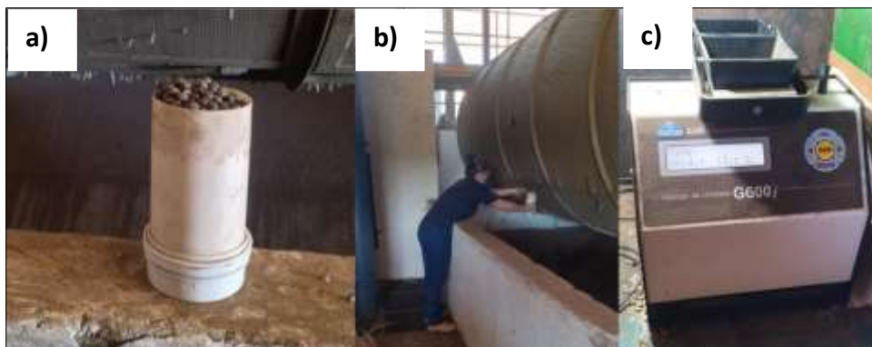
Figura 28 – a) Recipiente de PVC com a amostra; b) Retirando a amostra e c) equipamento G600 mostrando o teor de água do grão.
