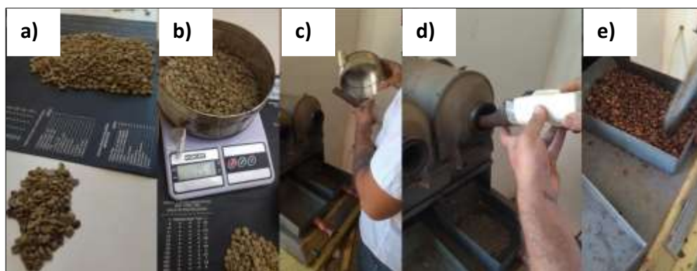
Figura 27 – a) Separação de defeitos da amostra; b) Pesagem da amostra; c) e d) Depositando a amostra no torrador e e) Café em torrefação média clara.
