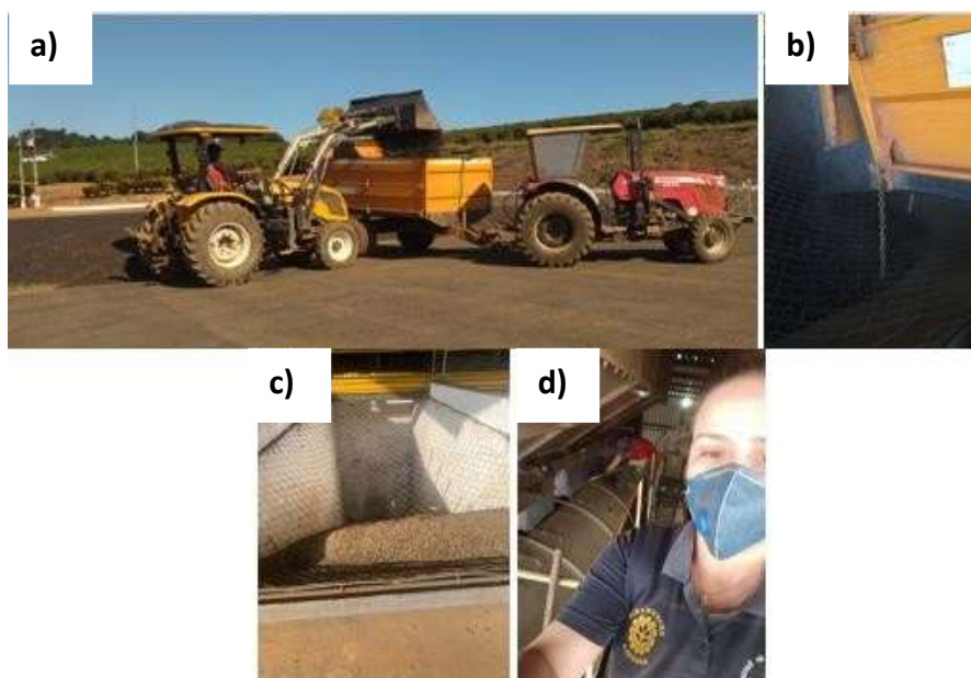
Figura 25 – a) Recolhimento do café no terreiro de asfalto; b) Café sendo depositado na moega; c) Café depositado e sendo transportado para tulha e d) Enchimento do secador.
