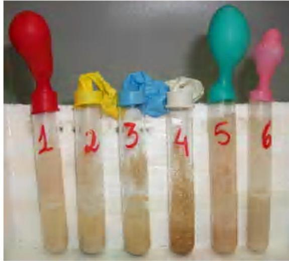
Figura 27: Mostra que ocorreu reação nos tubos 1, 5 e 6, o que pode ser observado pelos balões que foram inflados pelo  $\text{CO}_2$  produzido pela fermentação.
