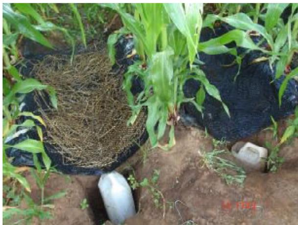
**Figura 5** Coleta da água precipitada que atingiu o solo no experimento da cultura do milho em recipientes plásticos, UFSM, Santa Maria, RS, 2006.
