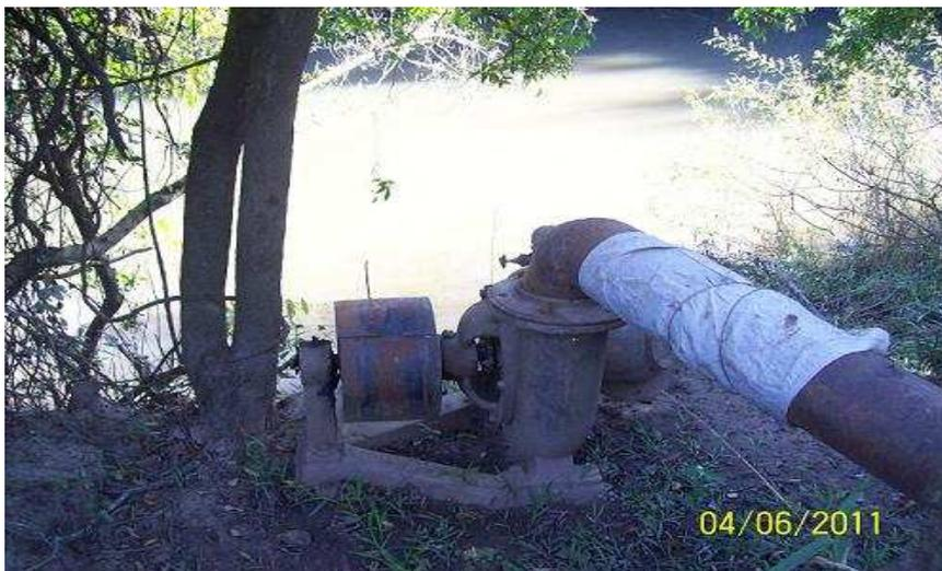
**Figura 2-** Bomba centrífuga utilizada para recalque de água para agricultura, Arroio Santa Bárbara, São Sepé, 2011. Fonte: Acervo do autor, 2011.
