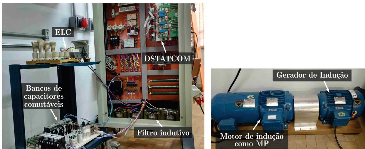
Figura B.2 – Fotografia do protótipo experimental utilizado na obtenção dos resultados.
