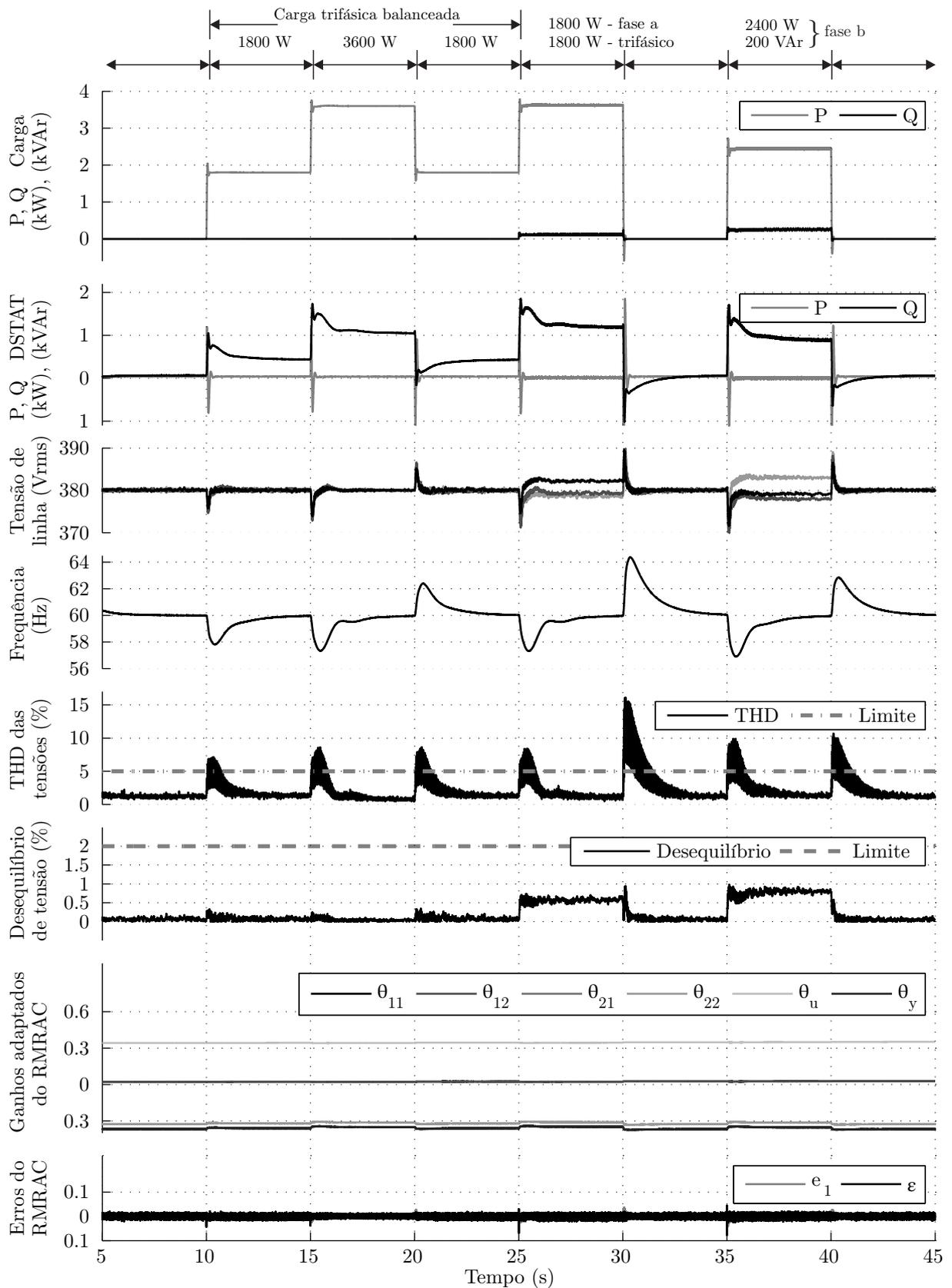
Figura 4.9 – Resultado de Simulação: Comportamento das variáveis do sistema mediante transitórios de carga empregando controlador RMRAC e máquina primária com velocidade variável.
