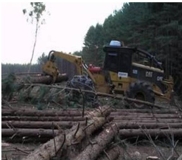
Figura 2 - *Grapple Skidder* Caterpillar 525 com garra.
