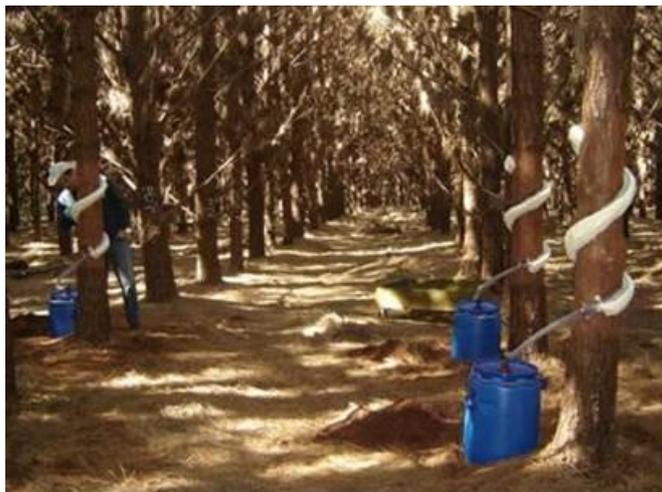
Figura 6 - Sistema coletor de água do escoamento pelo tronco.
