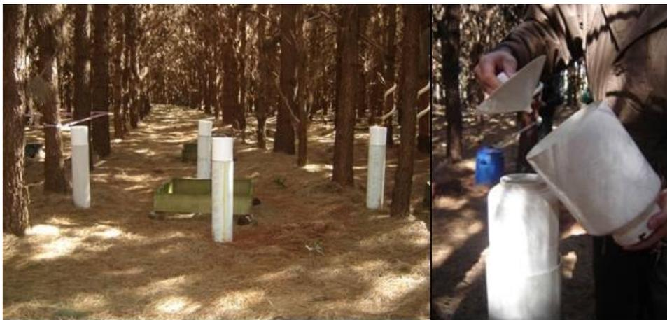
Figura 5 – Aspecto dos coletores da precipitação interna, vistos de uma repetição nas 4 posições, instalados no plantio de *Pinus taeda*.
