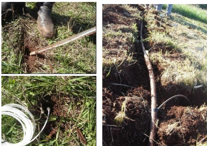
Figura 7 - Instalação dos lisímetros na área de campo, detalhe do lisímetro com ponta de cerâmica.
