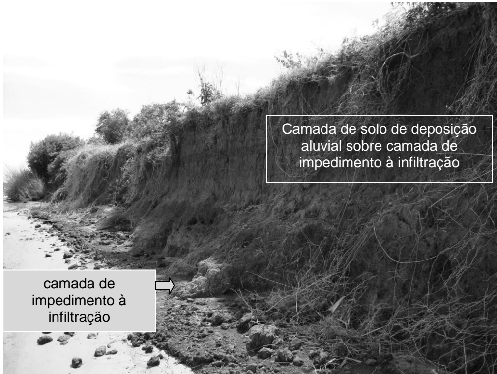
Figura 16 – Fotografia de barranco em queda, com a presença de zona de impedimento ao deslocamento vertical da água no solo. Iruí, Cachoeira do Sul, RS.
