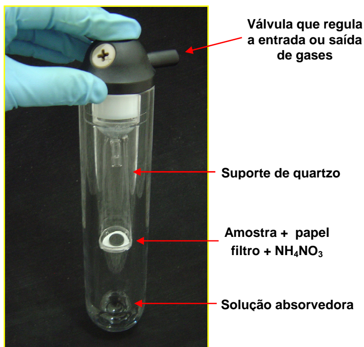
Figura 7. Amostra de carvão na base do suporte de quartzo, no interior do frasco, para a decomposição por MIC.
