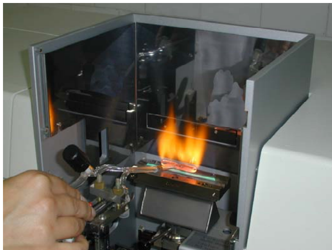
Figura 9. Vista parcial do sistema para SS-F AAS instalado em um espectrômetro de absorção atômica mod. AAS Vario 6 (Analytik Jena).
