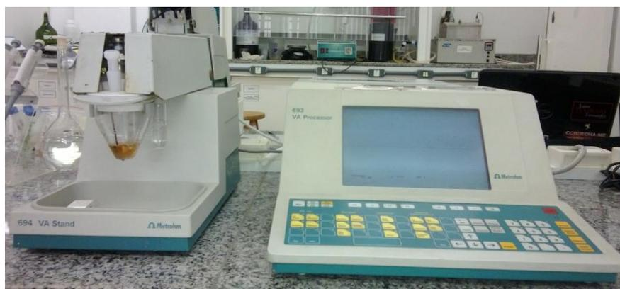
**Figura 11** - Foto do equipamento Processador 693 VA Processor (Metrohm) em conjunto com 694 VA Stand (Metrohm).
