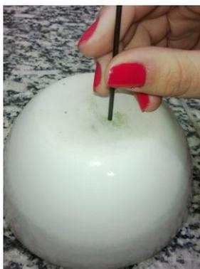
**Figura 10** - Procedimento para aplicação da amostra no eletrodo (friccionar o eletrodo sobre a amostra).
