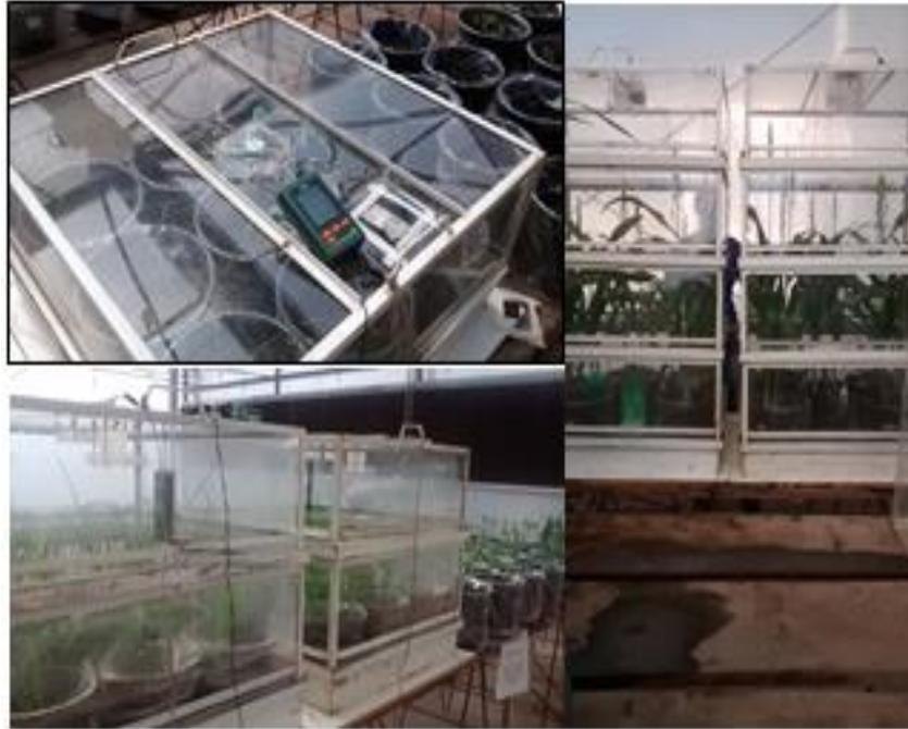
**Figura 1.** Dispositivo utilizado para o enriquecimento das plantas em condições de casa de vegetação. Dispositivo adaptado por Redin et al. (2012) com base nos estudos de Sangster et al. (2010) e Kong e Six (2010).
