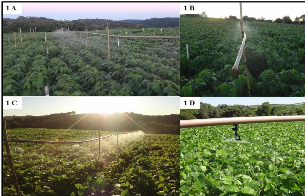
Figura 8 – Simulador de chuva desenvolvido para o experimento para aplicação dos tratamentos à campo (1A, 1B, 1C), detalhe do microaspersor (1D). Itaara – RS, 2013.
