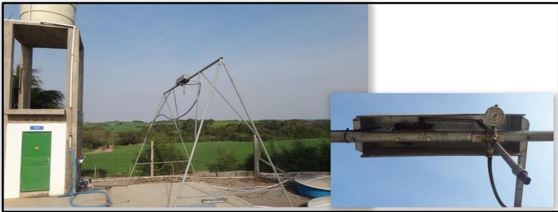
Figura 4 – Simulador de chuva desenvolvido por Debortoli (2008), para aplicação dos tratamentos em casa de vegetação. Itaara – RS, 2013.
