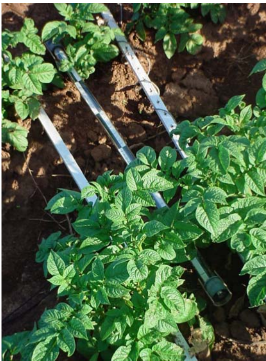
Figura 2. Tubo solarímetro instalado no interior da cultura da batata, cultivar Macaca, outono de 2004. Santa Maria, RS, 2004.
