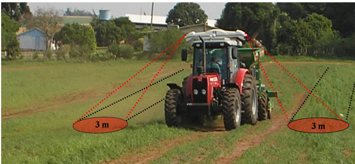
Figura 2 – Ilustração de “escaneamento” do N-Sensor ALS ® para aplicação à taxa variada em tempo real de fertilizante nitrogenado.
