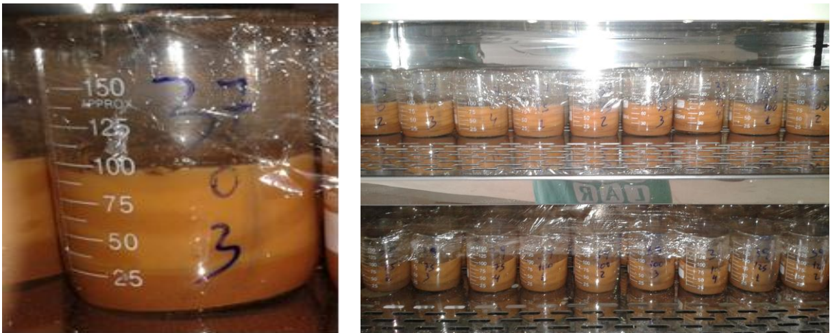
Figura 2 - Recipientes utilizados para incubação curta em estufa com ventilação forçada e temperatura controlada.
