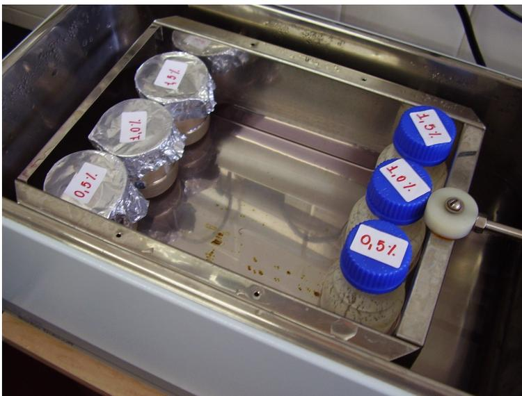
**Figura 7** - Amostras de iogurtes (porções) no banho termostatizado à 40°C, para determinação do valor de pH e acidez durante o processo de fermentação.
