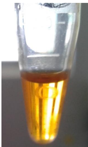
Figura 7 – Tubo contendo solução de ubiquinona em óleo de pracaxi após homogeneização em vórtex e microcentrifugação.
