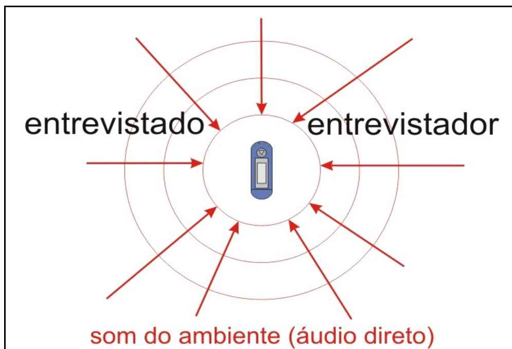
QUADRO 4 - raio de ação do microfone omni-direcional
