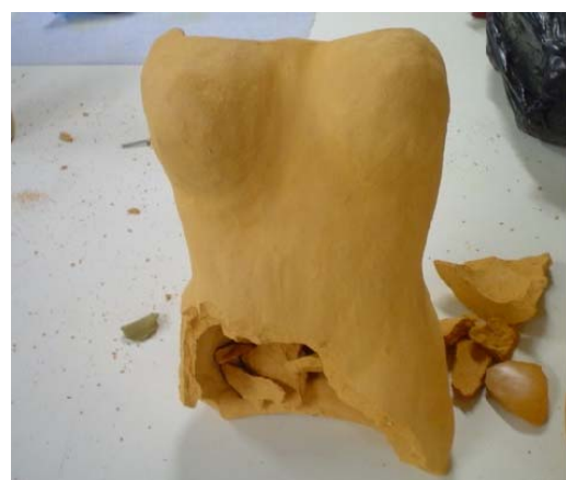
Fig.65. Peça danificada no processo de queima
