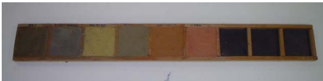
Fig.83. Amostras de argila da região – padronização para teste de plasticidade, retração e cor.
