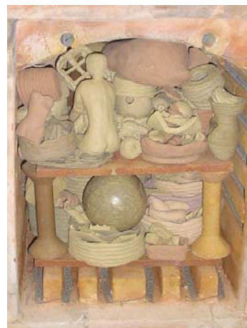
Fig.51.Organização do forno elétrico para queima
