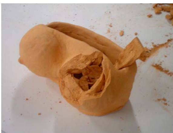
Fig.64. Peça danificada no processo de queima
