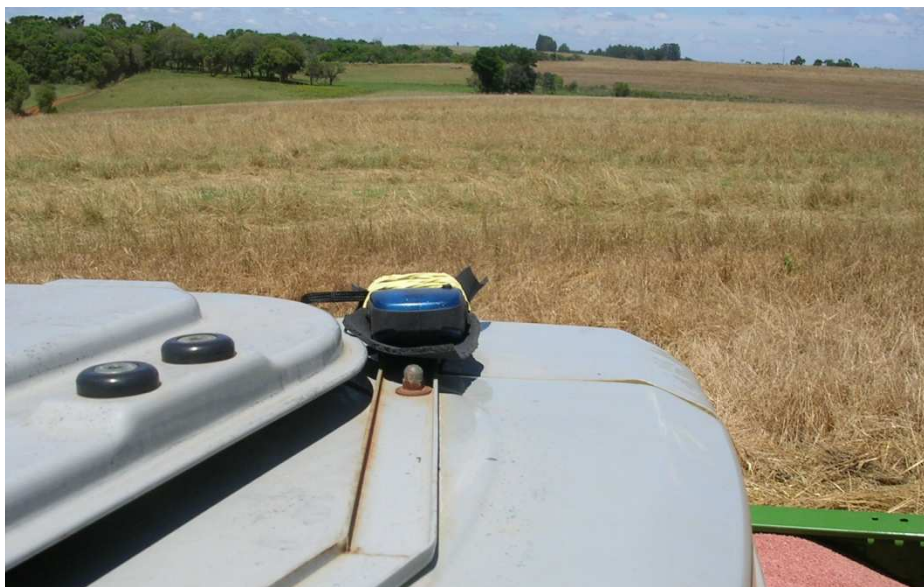
Figura 9 - Receptor de sinal GPS embarcado no trator.
