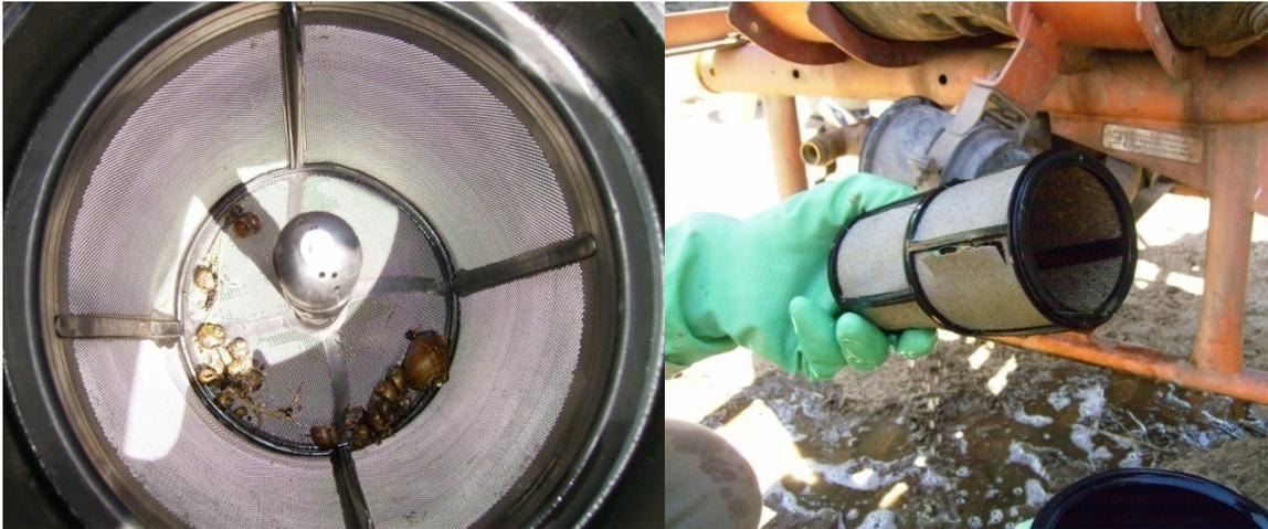
Figura 23 - Filtro do reservatório com resíduos e filtro da bomba de sucção com resíduos e com malha danificada.
