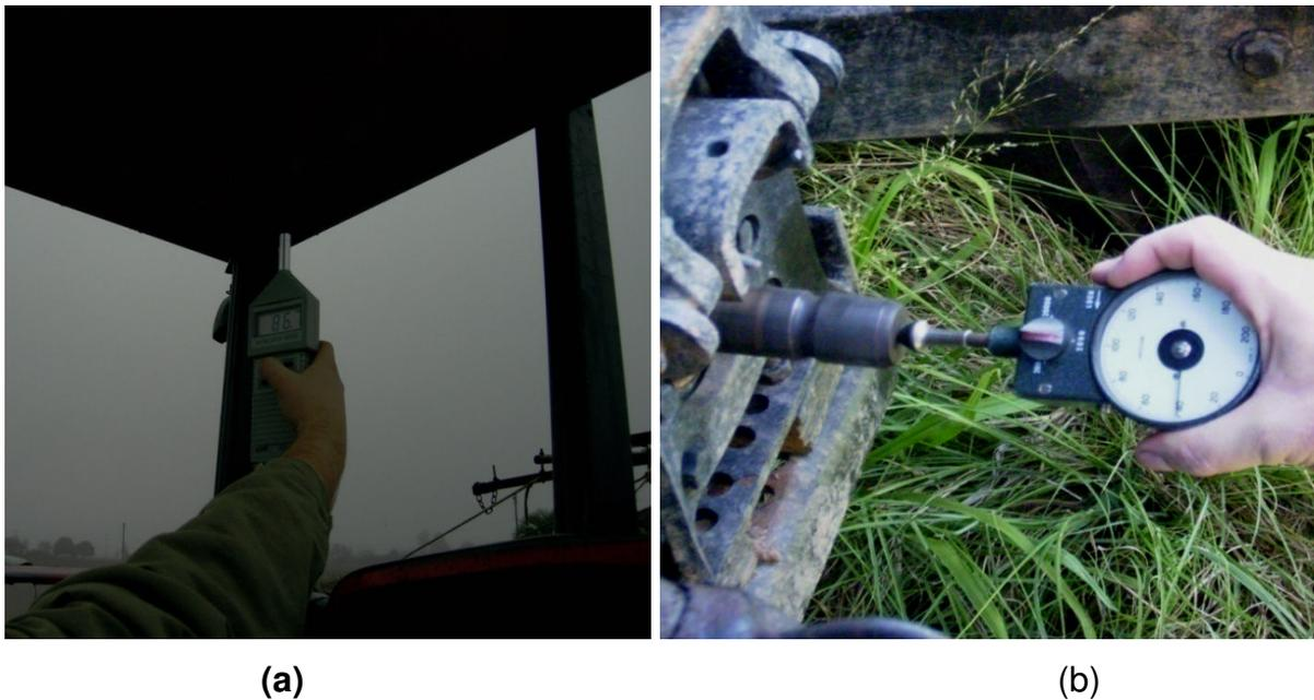
Figura 9 - Medição do ruído ao nível do ouvido do operador (a) e rotação da tomada de potência (b).
