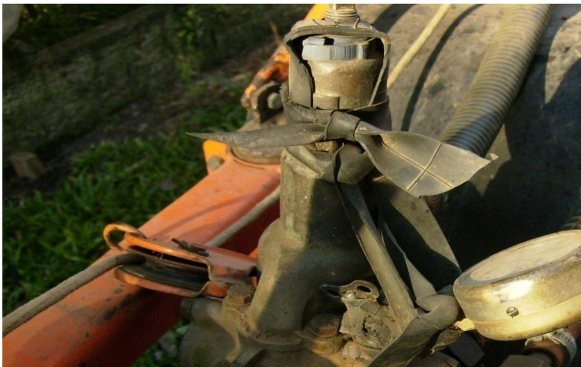
Figura 6 - Ilustração de regulador de pressão inadequado.
