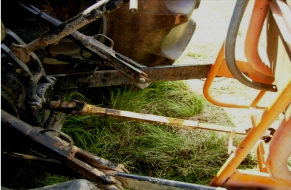
Figura 8 - Tomada de potência desprotegida sobre pulverizador em inspeção.
