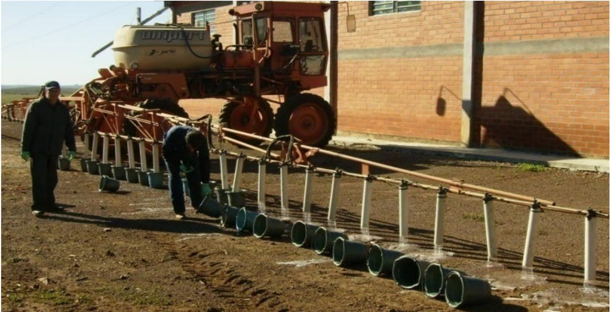
Figura 11 - Determinação de vazão por ponta de pulverização em pulverizador autopropelido. São Martinho da Serra, RS, 2008.
