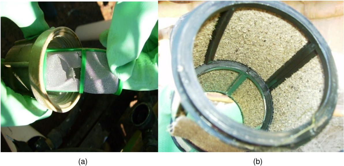
Figura 7 - Filtro com malha deteriorada (danificado) (a) e filtro com presença de resíduos (b).
