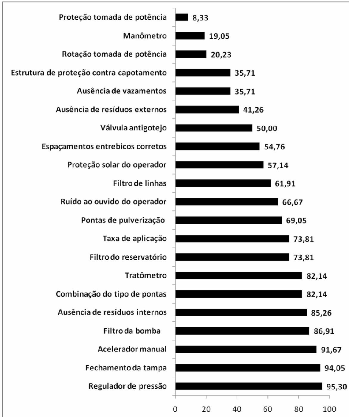
Figura 29 – Aprovação de itens avaliados durante a inspeção dos tratores e pulverizadores agrícolas.
