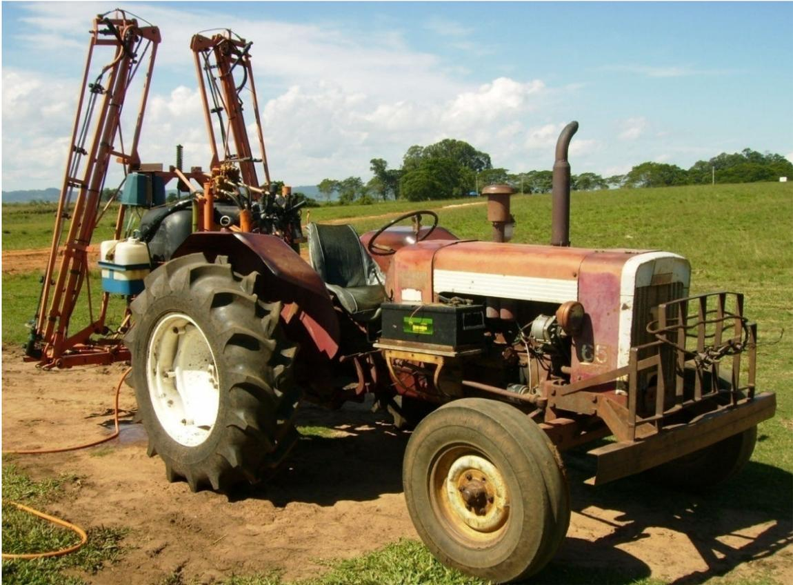
Figura 27 - Trator agrícola sem estrutura de proteção contra o capotamento e utilizado com pulverizador de engate aos três pontos do sistema hidráulico.
