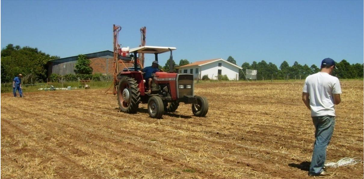
Figura 10 - Determinação da velocidade real de deslocamento do trator.
