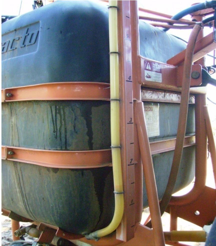
Figura 25 - Indicador de nível de calda com escala legível ao operador.
