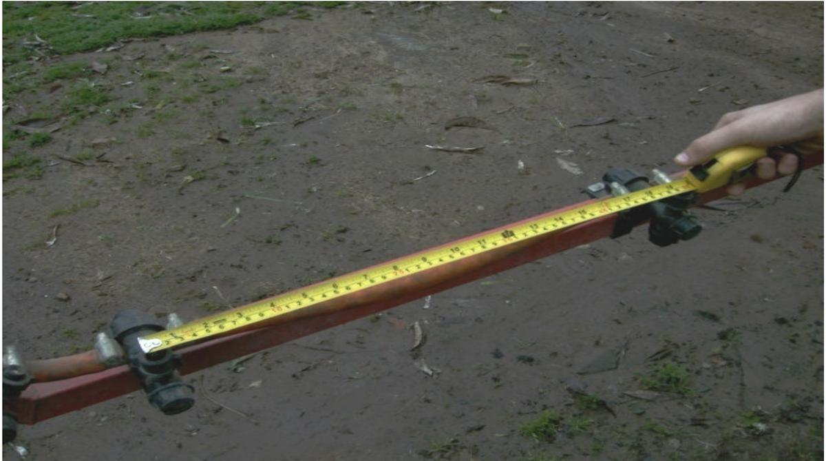
Figura 14 - Medição dos espaçamentos entrebicos sobre a barra de pulverização com uso de trena métrica.
