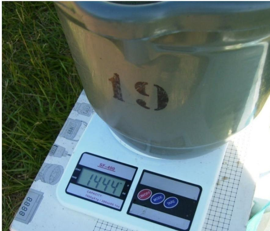
Figura 13 - Pesagem dos volumes individuais de calda coletados nas pontas de pulverização.
