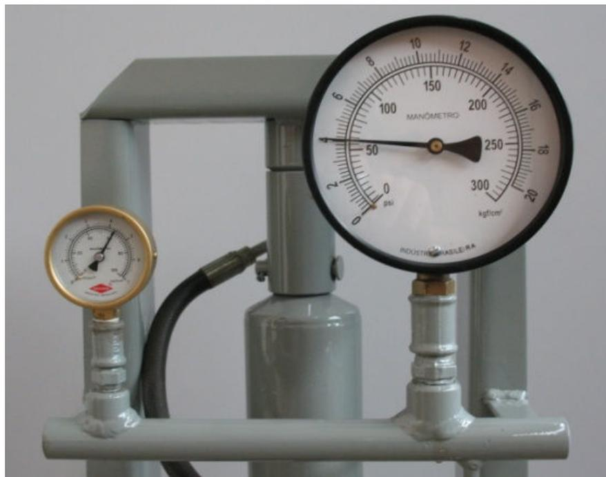
Figura 21 - Manômetro inadequado sendo inspecionado sobre bancada de teste.
