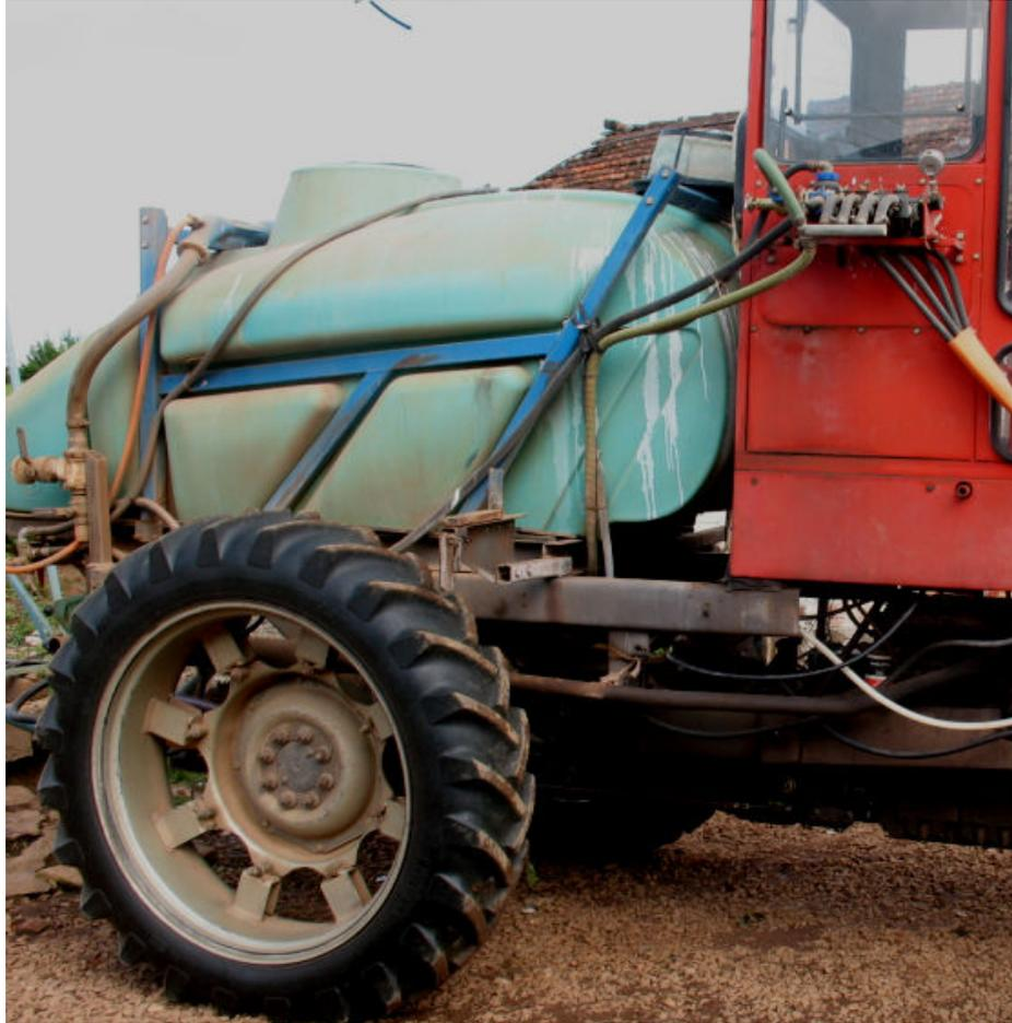
Figura 26 - Presença de resíduos na parte externa do reservatório de calda de agrotóxicos.
