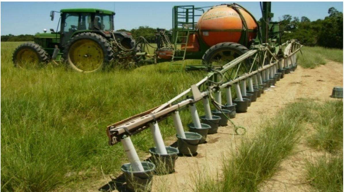
Figura 12 - Determinação de vazão por ponta de pulverização em pulverizador com engate de arrasto. São Sepé, RS, 2008.
