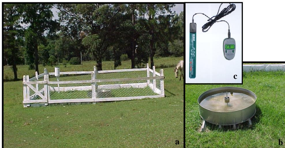
**Figura 06** - Estação meteorológica, (convencional) (a), tanque de evaporação (b) e sensor de umidade do solo (c). Jaguari, RS, 2007.
