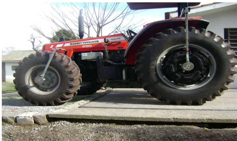
Figura 5 - Trator teste utilizado, mostrando a montagem da instrumentação eletrônica (Russini, 2009)
