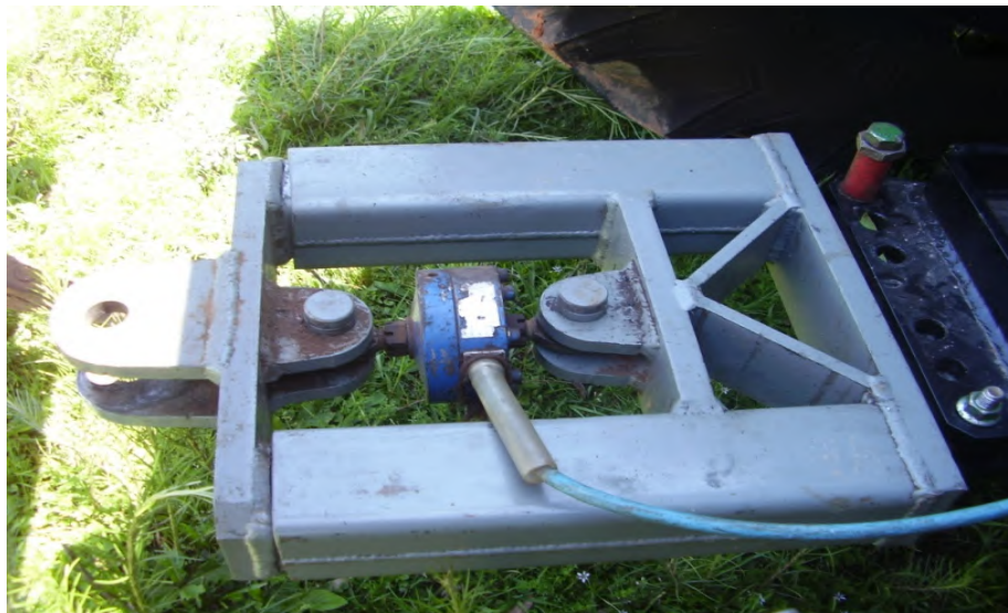
Figura 16 – Barra de tração retrátil com a célula de carga
