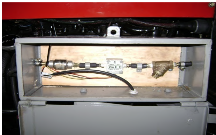
Figura 17 – Fluxômetro para medida do consumo de combustível do trator teste
