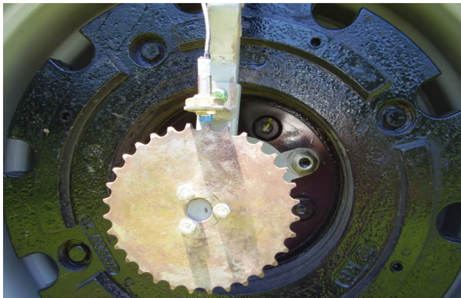
Figura 14 – Sensor e engrenagem na roda do trator teste
