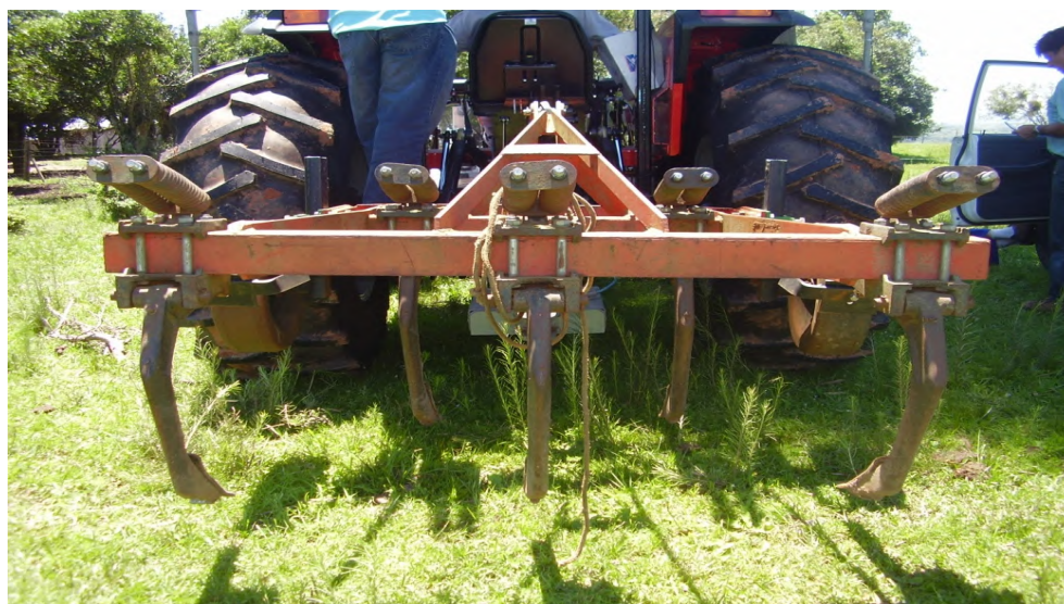
Figura 10 – Escarificador de cinco hastas
