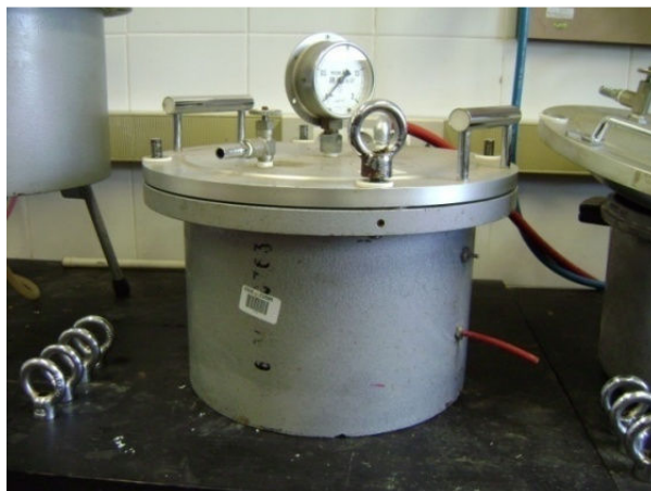
Figura 9 - Equipamento utilizado para determinação do conteúdo de água do solo para a aplicação de tensões de 30 e 100 kPa.
