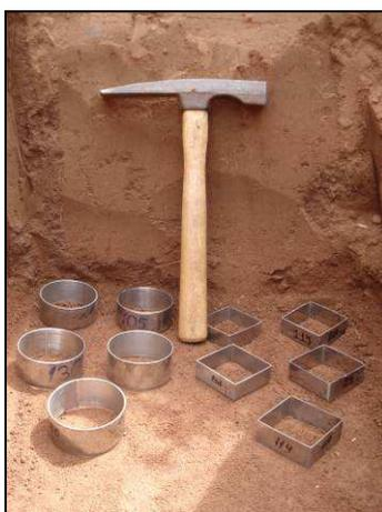
FIGURA 4 – Cilindros e caixas metálicas utilizados para a coleta de solos com estrutura preservada. Foto: Braga, 2008
