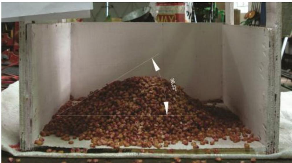
Figura 12 - Determinação do ângulo de repouso de sementes de milho.
