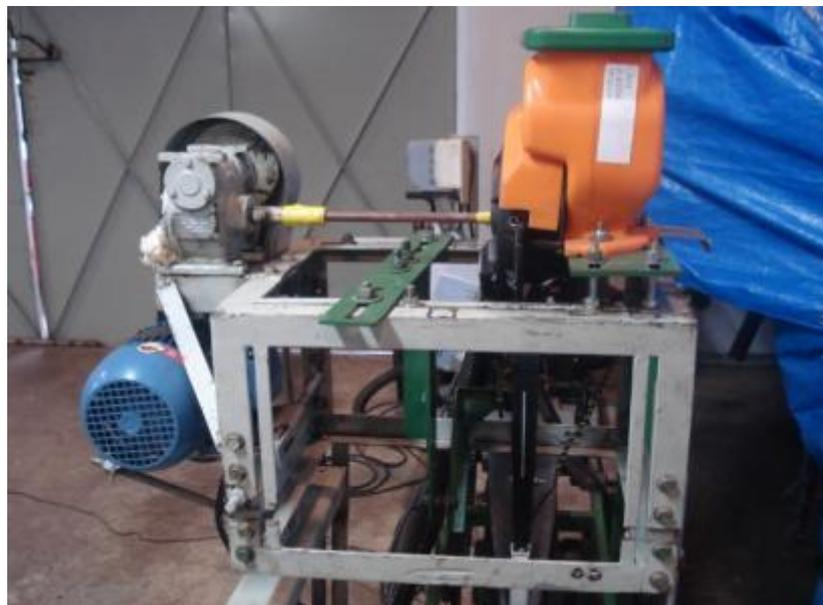
Figura 7 - Dosador Pneumático *Planting Precision*<sup>®</sup>.
