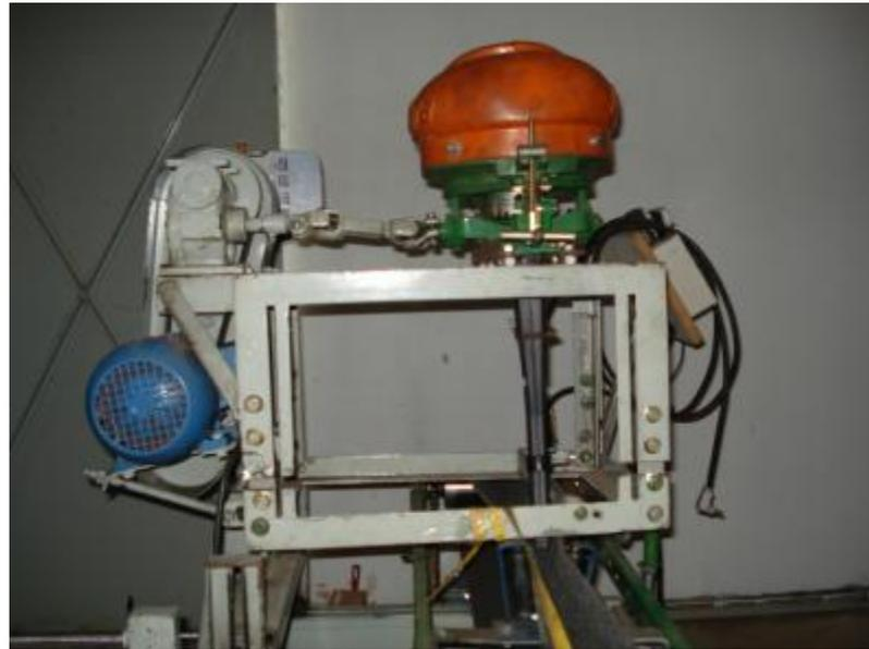
Figura 9 - Dosador de discos horizontais STARA®.
