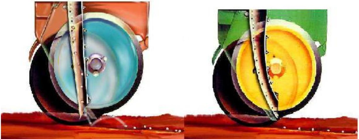
Figura 1 - Influência da conformação do tubo condutor na liberação das sementes.
