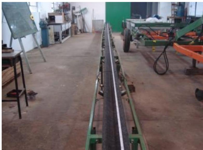
Figura 6 - Esteira utilizada para deposição de sementes e simulação de deslocamento da semeadora, desenvolvida no LASERG e descrita por Silveira et al. (2010) e Alonço et al. (2010).
