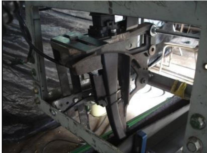
Figura 10 - Suporte de fixação de tubos condutores na bancada de ensaio.
