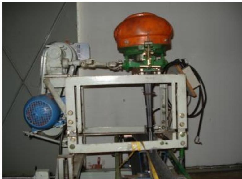
Figura 5 - Bancada de ensaios de dosadores de sementes, desenvolvida no LASERG e descrita por Silveira et al. (2010) e Alonço et al. (2010).
