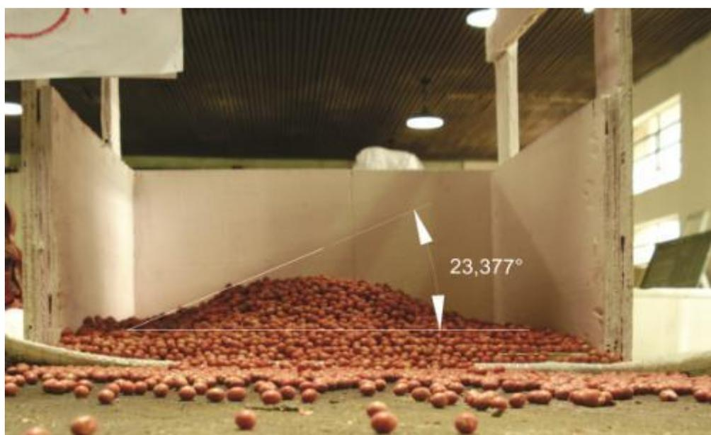
Figura 13 - Determinação do ângulo de repouso de sementes de soja.
