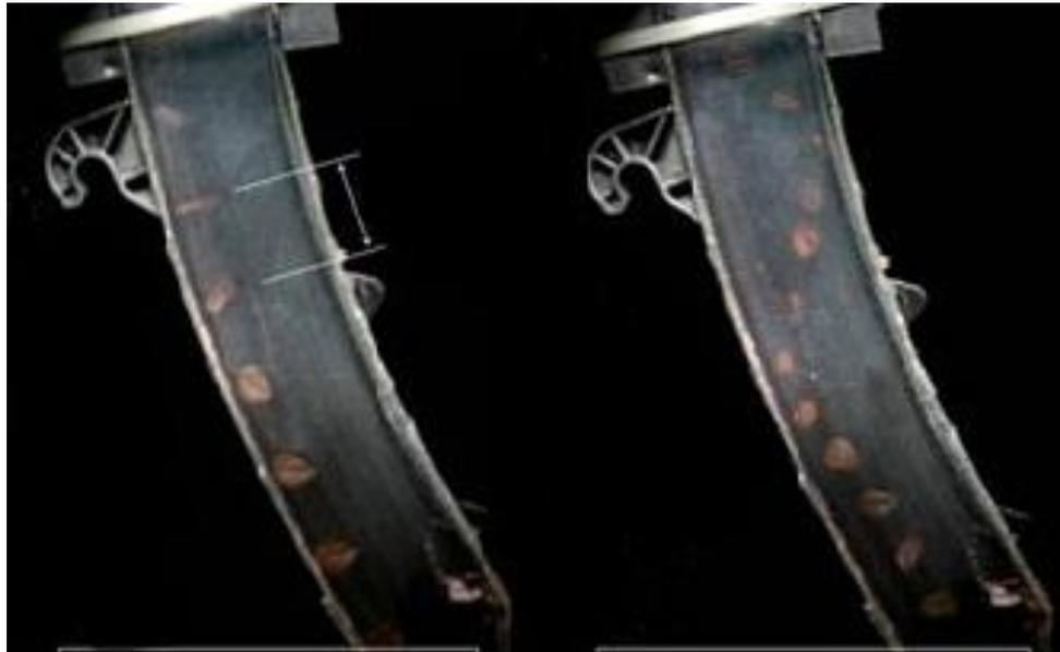
Figura 4- Variação de trajetória da semente dentro do tubo condutor, proporcionando atraso na queda da semente. Fonte: DEERE E COMPANY (1996).
