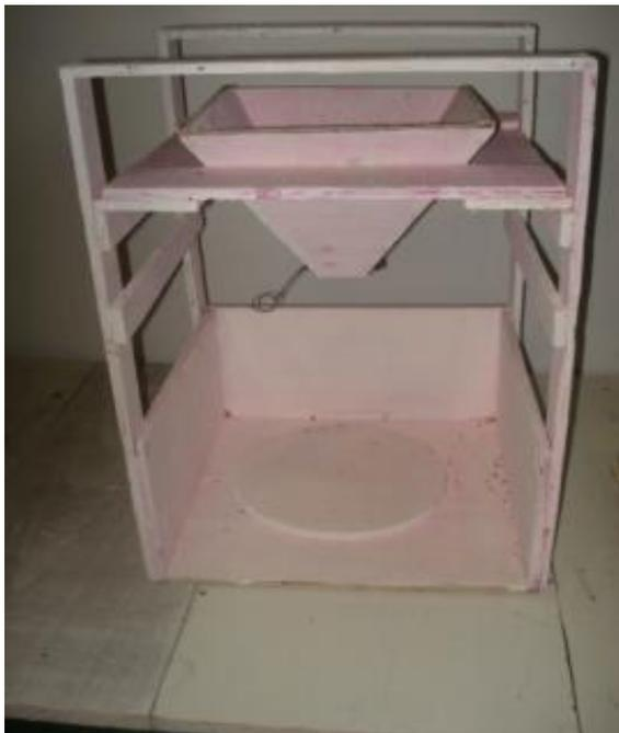
Figura 11 - Dispositivo utilizado para determinação do ângulo de repouso das sementes.
