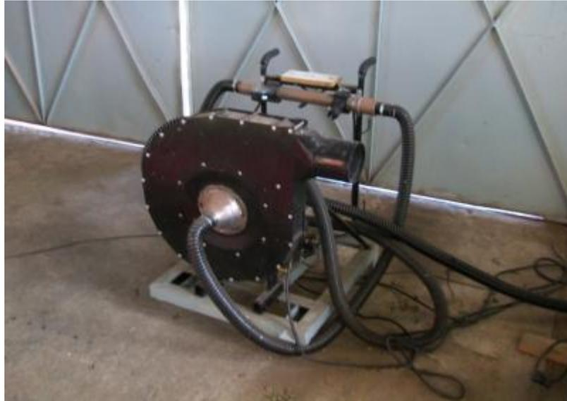
Figura 8 - Ventilador centrífugo Matermacc<sup>®</sup> para geração do Vácuo do dosador pneumático.
