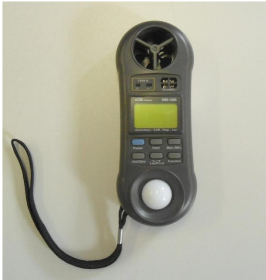
Figura 15 - Termo-higrômetro da marca Icel, modelo WM-1850, utilizado para a determinação momentânea das condições atmosféricas.
