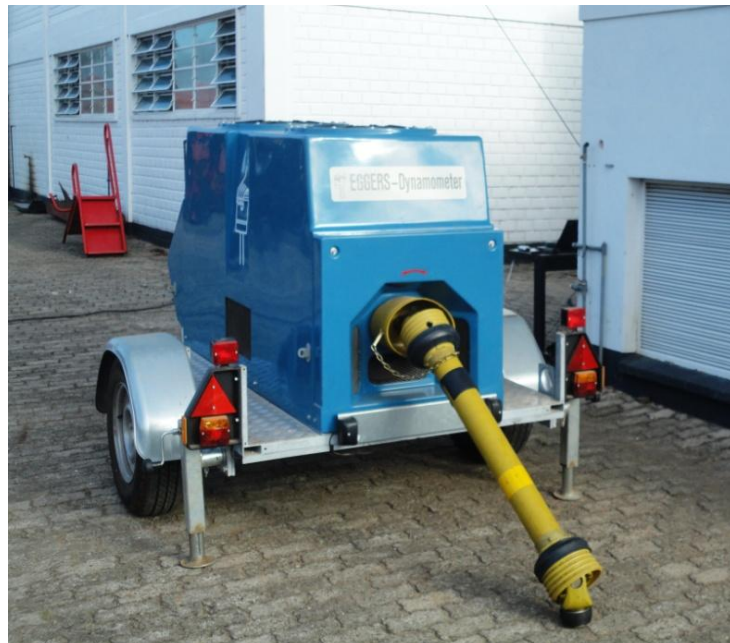
Figura 10 - Dinamômetro móvel da marca EGGERS, modelo PT 301 MES utilizado na condução dos ensaios de motores agrícolas.
