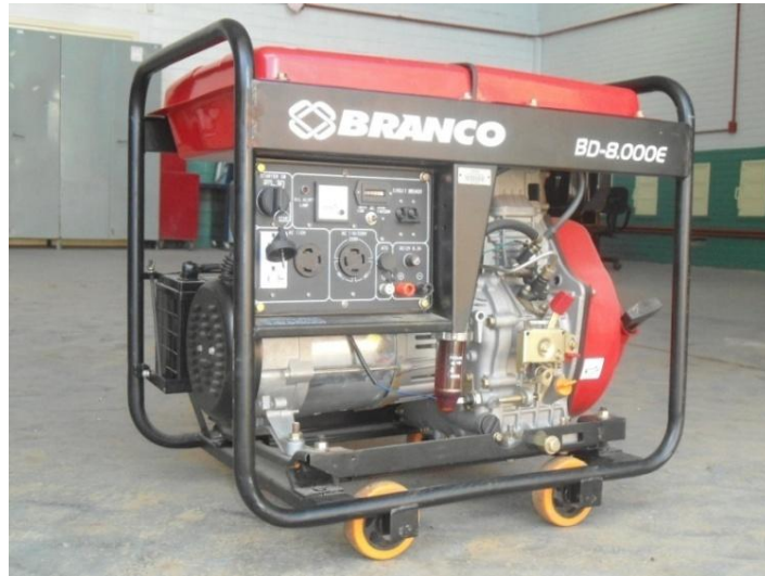
Figura 13 - Gerador de energia elétrica da marca Branco, modelo BD-8000 E, utilizado para o acionamento do dinamômetro móvel.
