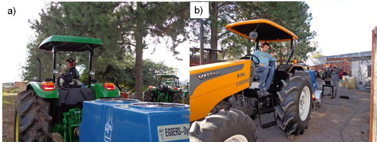
Figura 23 - Medição do nível de ruído que chega ao ouvido do operador (a) e procedimento utilizado para realização de tal medição (b).
