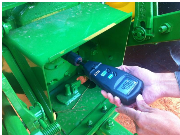
Figura 14 - Tacômetro foto/contato digital da marca Minipa, modelo MDT-2238A, utilizado para a determinação das rotações da TDP e do motor dos tratores agrícolas avaliados.
