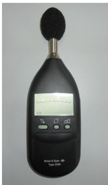
Figura 16 - Decibilímetro da marca Brüel & Kjær, modelo type 2240, utilizado para avaliação do nível de ruído no posto de operação durante os ensaios.
