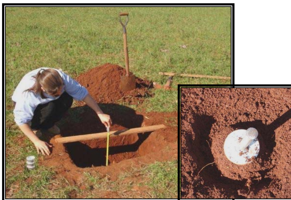
Figura 03 - Abertura da trincheira para coleta de amostras para determinação das características físicas do solo com detalhe do coletor de amostras. Santiago, RS, 2005.
