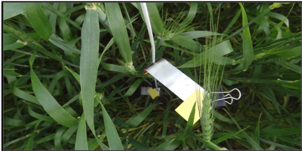
Figura 5 – Detalhe da haste sustentando os cartões no terço superior e inferior do dossel para amostragem das gotas na terceira aplicação. Itaara – RS, 2015
