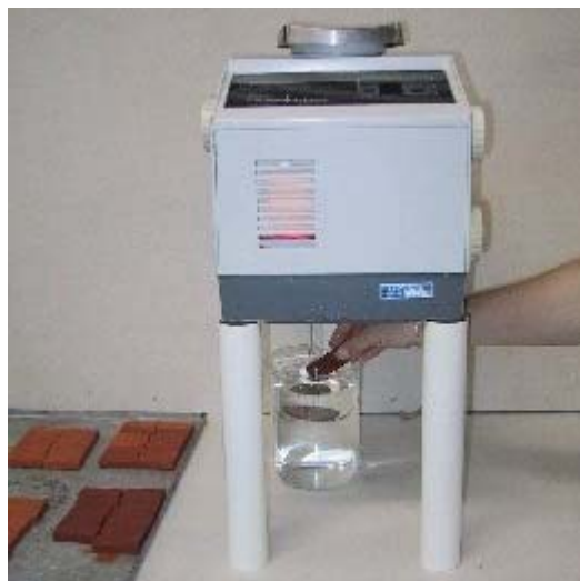
Figura 3.9- Determinação da massa imersa de corpos de prova
