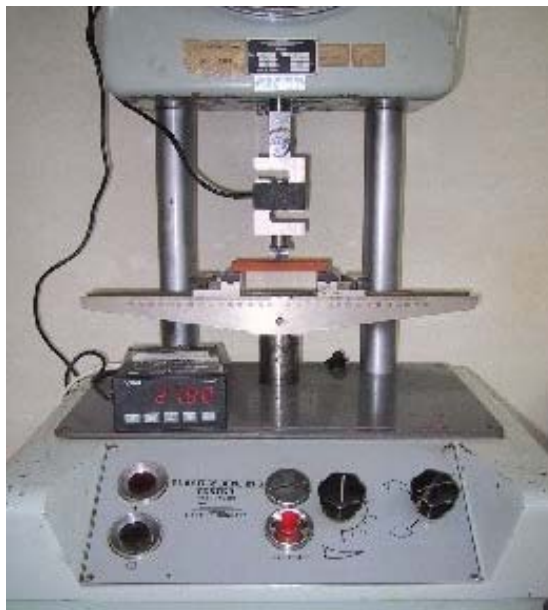
Figura 3.8 - Ruptura a flexão simples (método dos três pontos)
