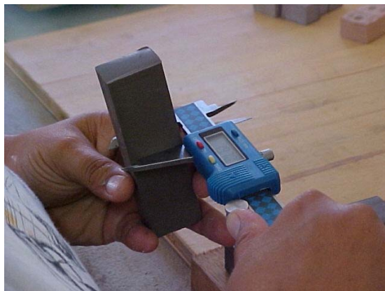
Figura 3.6 - Verificação dimensional após moldagem
