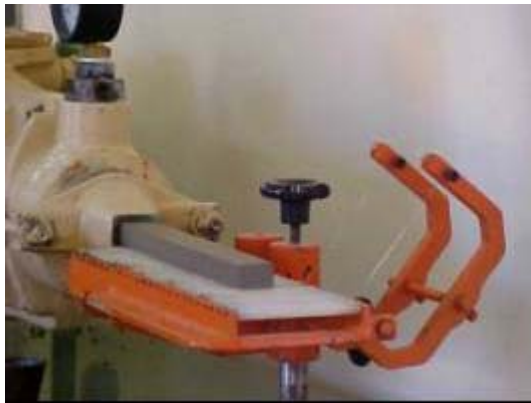
Figura 3.3 – Extrusão a vácuo
