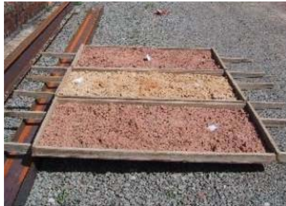
Figura 3.2 - Secagem ao ar de amostras de argilas
