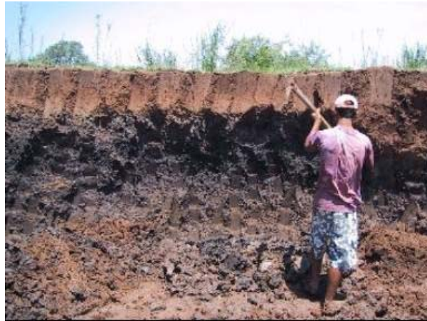
Figura 3.1 – Coleta de amostra de argila
