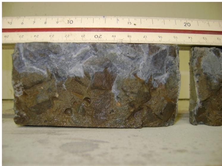
Figura 4.3 – Corpo-de-prova após aspensão de solução de nitrato de prata após ensaio ASTM C1202/05.
