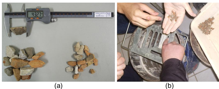
Figura 26 – Determinação do (a) índice de forma e (b) lamelaridade. Fonte: Acervo do Autor (2011).
