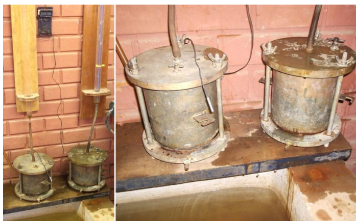
Figura 28 – Ensaio de percolação com carga variável. Fonte: Acervo do Autor (2011).
