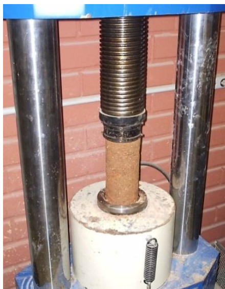
Figura 29 – Execução do ensaio de resistência à compressão simples. Fonte: Acervo do Autor (2011).
