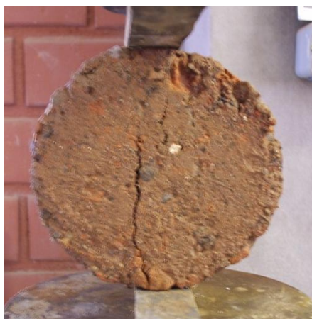
Figura 90 – Execução do ensaio de RTCD: amostra no instante da ruptura. Fonte: Acervo do Autor (2011).
