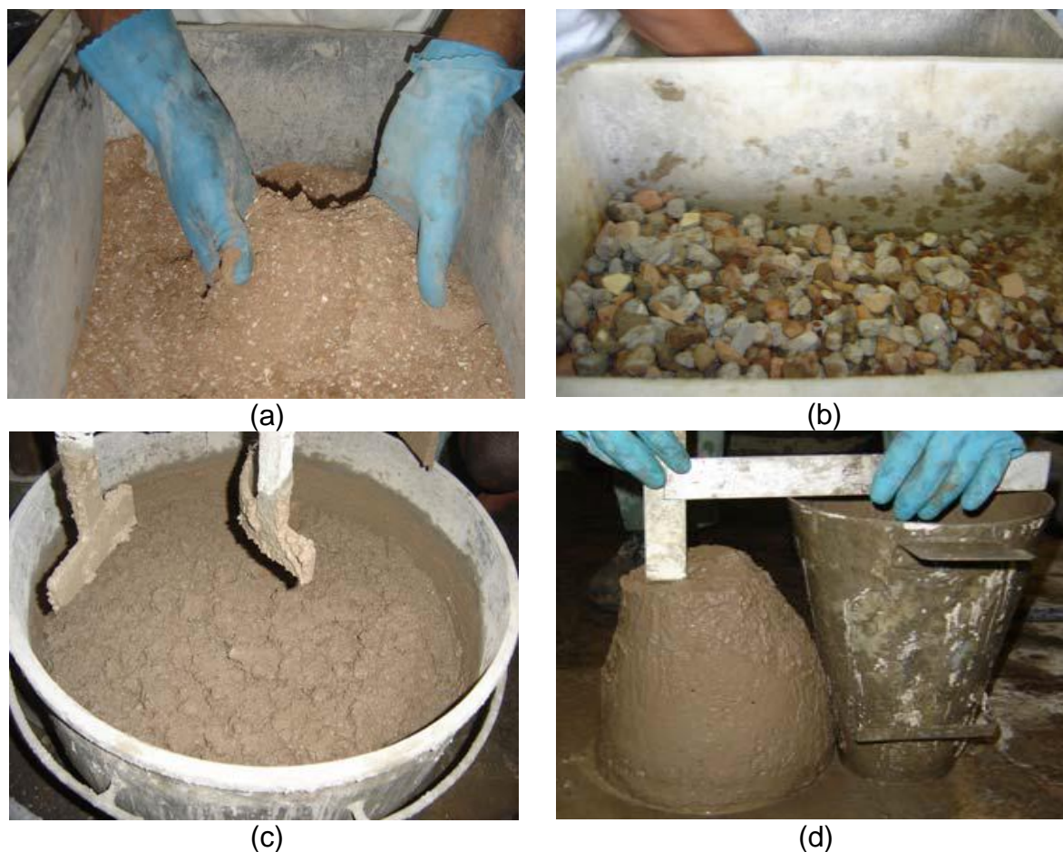
Figura 13 – Concreto produzido com agregado reciclado: (a) agregado miúdo, (b) agregado graúdo, (c) aspecto do concreto após a mistura e (d) verificação do abatimento. Fonte: Lovato (2007).
