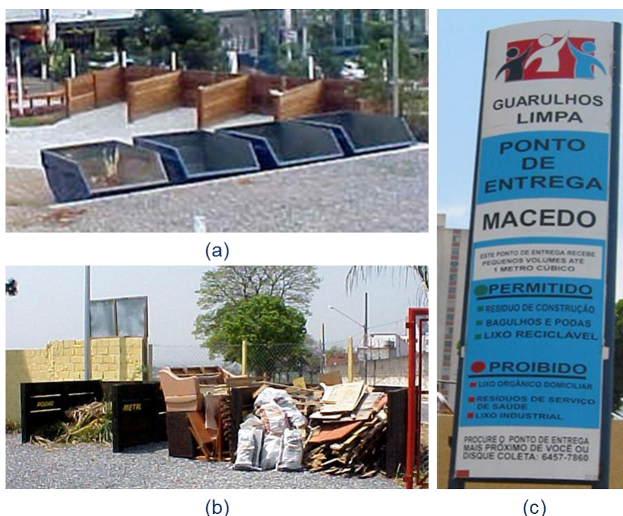
Figura 68 – Exemplo de Ponto de Entrega Voluntária (PEV): (a) caçambas para o descarte de RCC, (b) baias para descarte de resíduos volumosos, (c) identificação e descrição dos resíduos permitidos. Fonte: Prefeitura Municipal de Guarulhos-SP.
