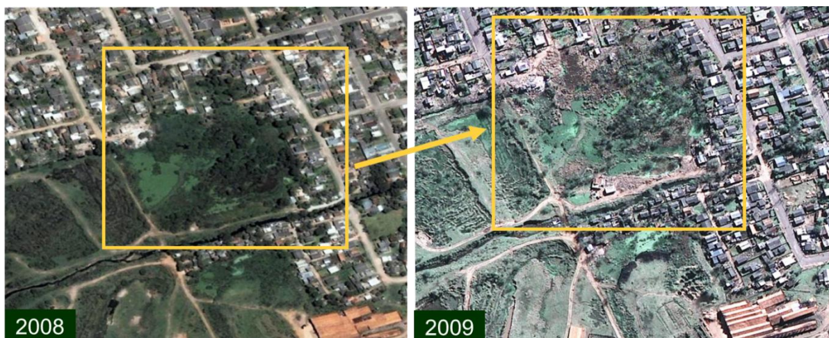
Figura 37 – Evolução da degradação ambiental causada pela disposição clandestina de RCC em local da periferia de Santa Maria, aproximadamente 80% da área foi degradada após um ano do início do descarte irregular. Fonte: Acervo GR2 (2010).
