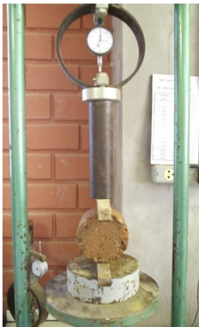
Figura 30 – Execução do ensaio de resistência à tração por compressão diametral. Fonte: Acervo do Autor (2011).
