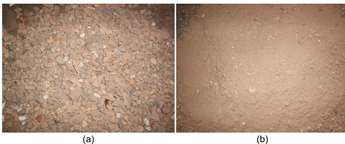
Figura 74 – Ensaio de abrasão “Los Angeles”, (a) agregados antes e (b) depois da realização do ensaio.
