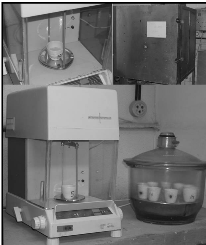
Figura 2.16 – Ensaio de água combinada: Balança, Mufla e Dessecador.
