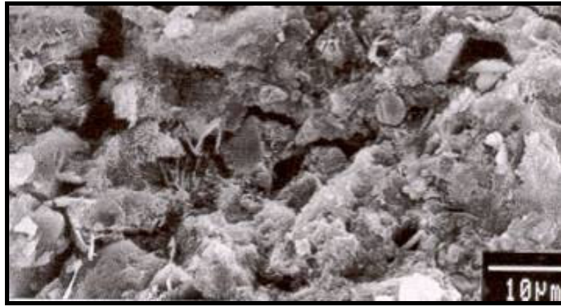
Figura 1.4 – Produtos externos da hidratação (AITCIN, 2000).
