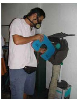
Figuras 42 e 43 – Etapa de acabamento com disco de lixa em alta rotação
