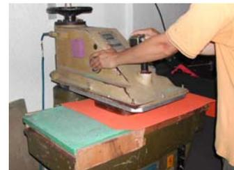
Figuras 39 e 40 – Máquina para a etapa do corte de E.V.A. com a navalha em balancim
