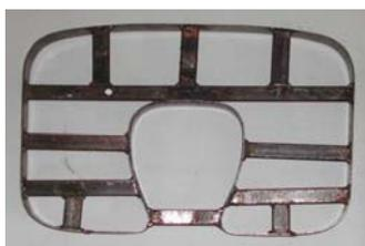
**Figura 38** – Navalha de aço forjado com configuração de posicionador cervical
