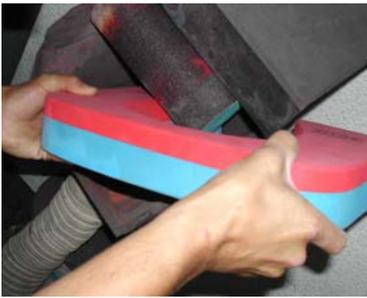
Figura 44 – Detalhe da etapa de acabamento com lixa
