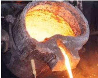
**Figura 11:** Panela de vazamento.
