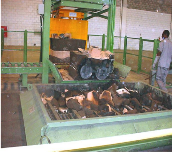
**Figura 12:** Máquina de Desmoldagem.
