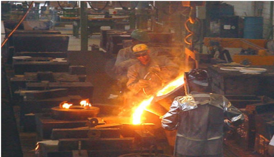
**Figura 10:** Linha de produção em processo de vazamento.
