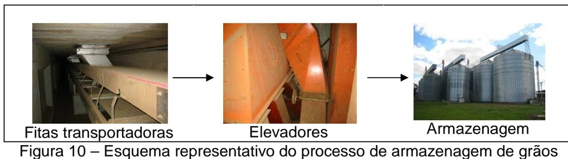
Figura 10 – Esquema representativo do processo de armazenagem de grãos
