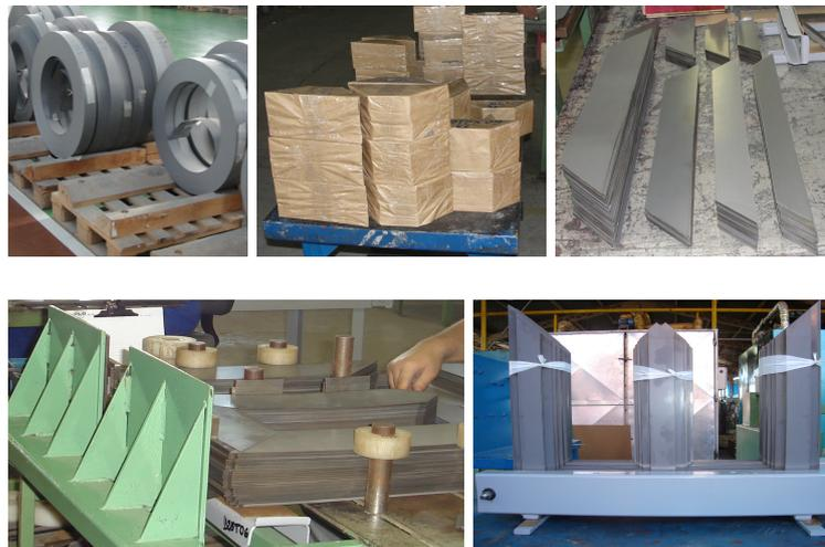
Figura 16 - Processo montagem de núcleo de silício.
