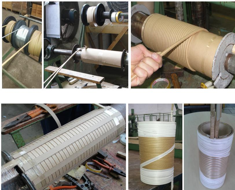
Figura 14 - Processo fabricação bobinas baixa tensão.
