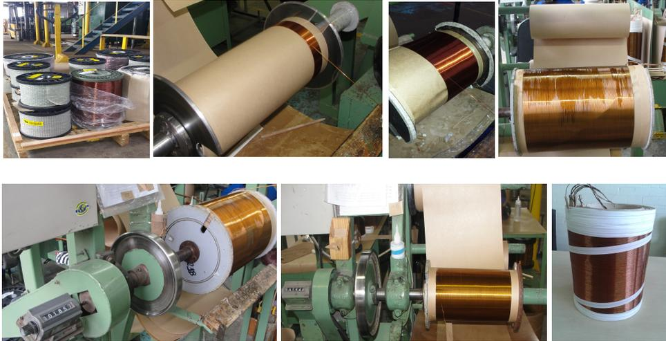
Figura 15 - Processo fabricação bobinas de alta tensão.
