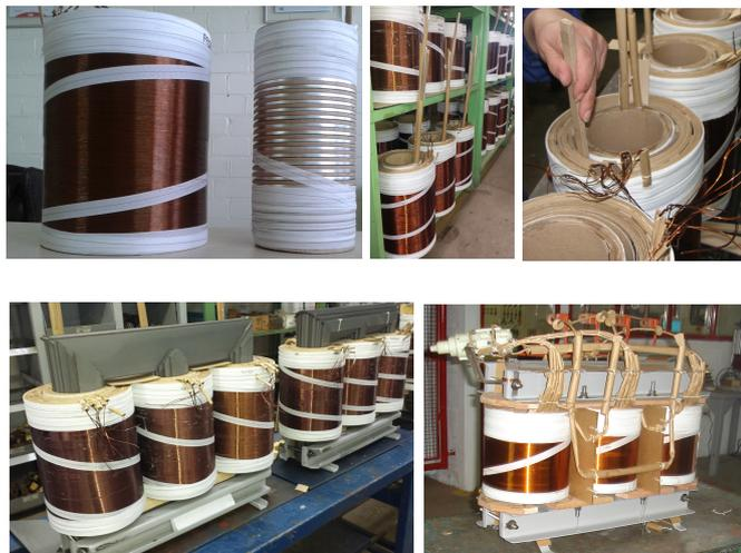
Figura 18 - Enrolamento e ligação elétrica do transformador de alumínio.
