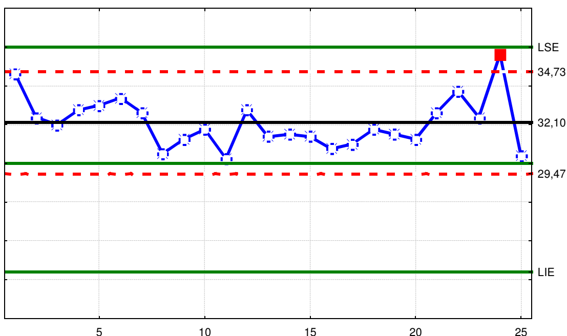
FIGURA 20 - Gráfico x-barra para peso batter (Fase 2)
