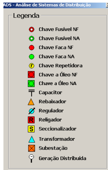
FIGURA 5.9: Simbologia empregada para representação dos elementos elétricos.
