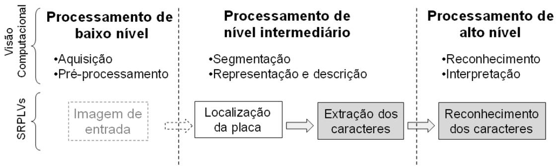
**Figura 4.1 – Relação entre os principais módulos de um SRPLV e a classificação de três níveis adotada na área de visão computacional.**
