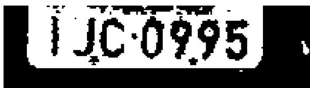
**Figura 2.16 – Ilustração da imagem obtida pelo processo de binarização da região da placa de licenciamento veicular.**
