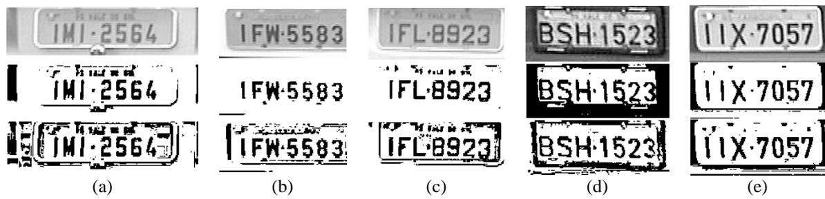
**Figura 5.5** – Alguns dos resultados obtidos a partir das técnicas de limiarização avaliadas. As imagens originais (256 tons de cinza) estão dispostas na primeira linha, enquanto as obtidas pela técnica de Otsu na segunda e por Niblack na terceira.
