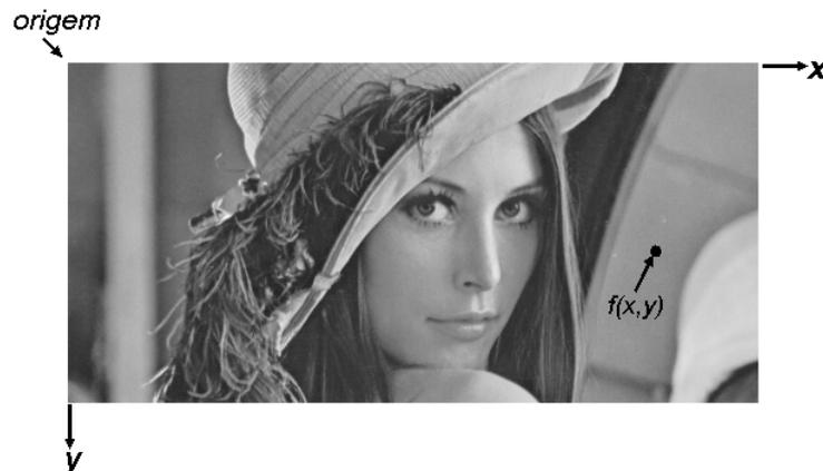
**Figura 2.1** – Ilustração de uma imagem digital, composta por uma coleção de elementos discretos  $f(x,y)$  e definida num plano cuja origem se situa no canto superior esquerdo.
