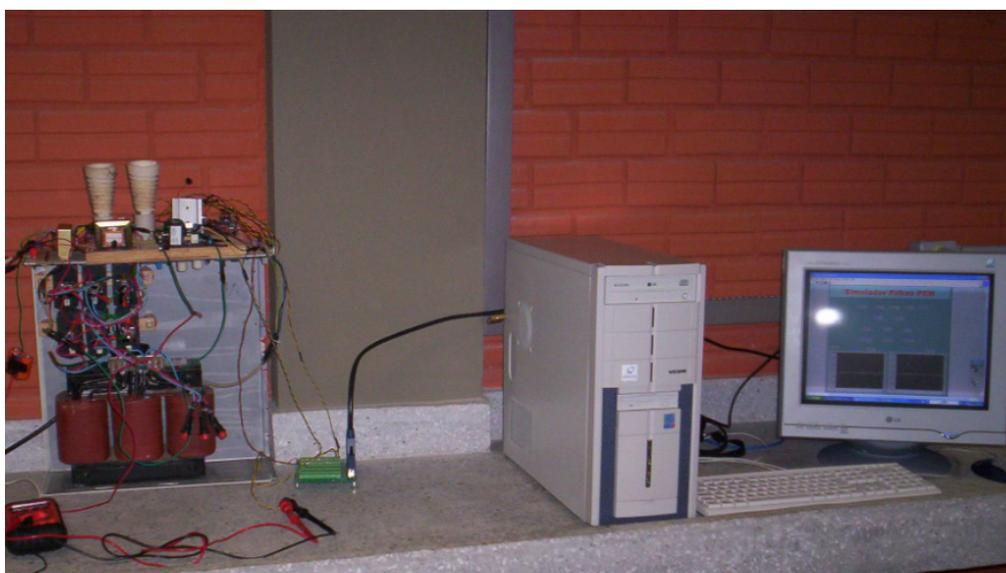
Figura A01.3 – Foto do simulador eletroquímico ligado a placa de aquisição
