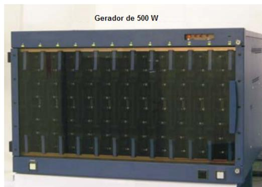
Figura 4.13 – Foto de um gerador SR-12 de 48 células (12 cartuchos)
