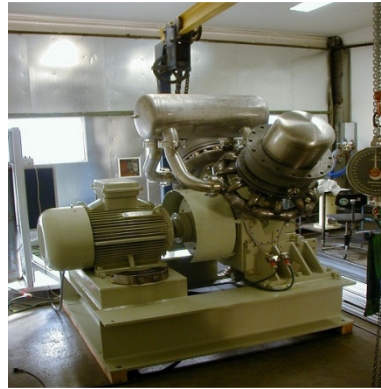
Figura 16– Foto de um grupo motor gerador com a utilização do motor Stirling. Fonte: Lora, 2005
