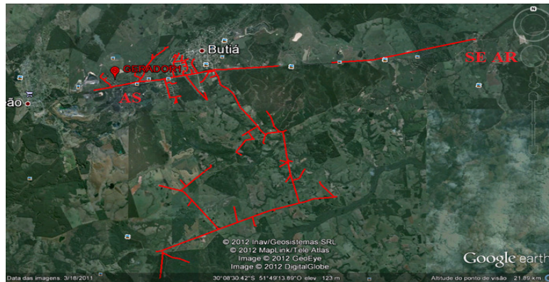
Figura 23 – Ilustração do AL03 e suas ramificações com a conexão do aterro onde se encontra a GD AS, georreferenciado pelo software Google Earth®. Fonte: PSL®DMS, versão Demo 1.0.1.1 da Powersyslab Engenharia e Sistemas Ltda.
