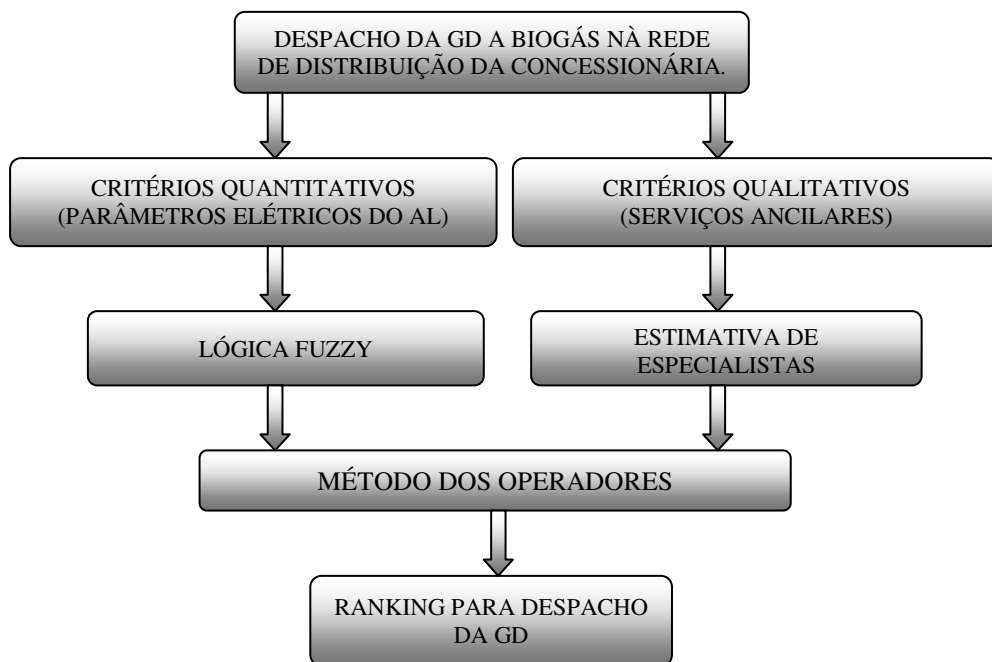
Figura 19 – Fluxograma representando a metodologia proposta para determinar o ranking horário para o despacho da GD à rede de distribuição.
