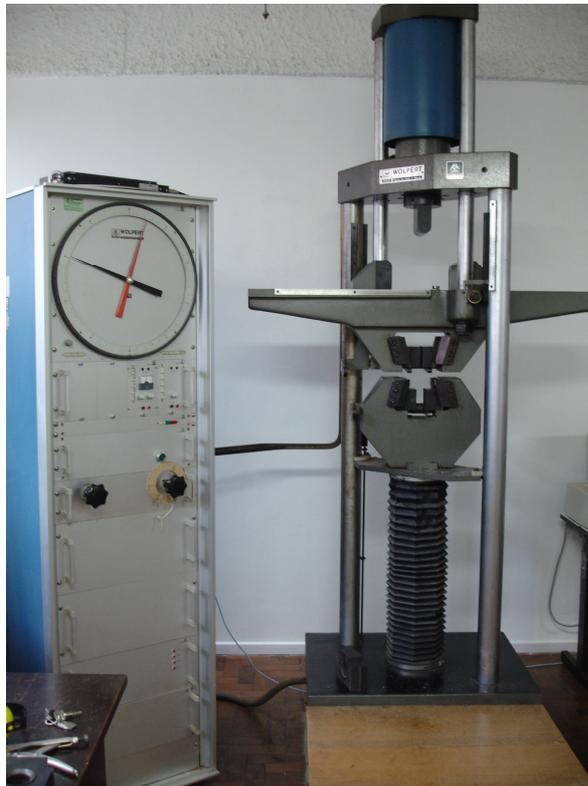
**Figura 7 - Máquina universal de ensaios**
