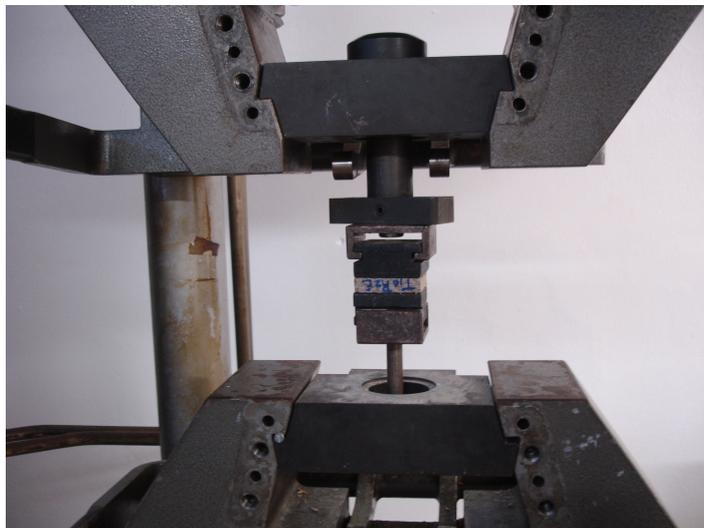
Figura 9 - Teste de tração perpendicular à superfície do painel
