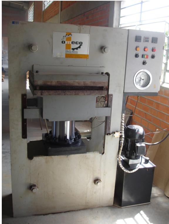
**Figura 5 - Prensa hidráulica de laboratório.**
