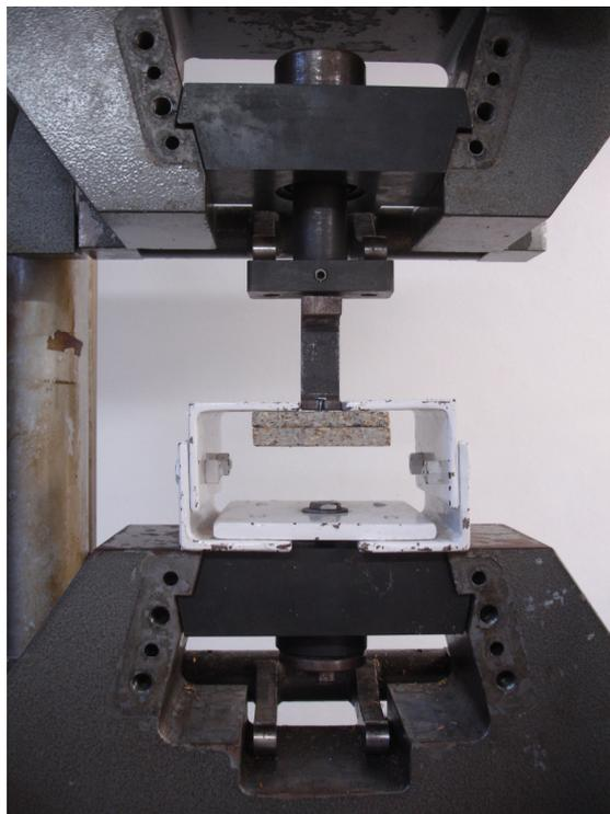
**Figura 8 - Teste de arrancamento de parafusos**
