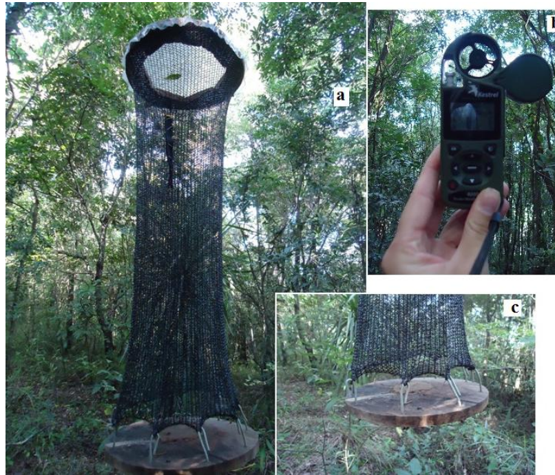
Figura 2 - Armadilha no fragmento “B”, fixada em galho de árvore (a); Termo-Hidro-Anemômetro digital sendo utilizado no interior do fragmento para obtenção das variáveis microclimáticas de temperatura, umidade relativa do ar e velocidade do vento (b); plataforma de madeira (sobre a qual era depositada a isca), fixada a fios de arame, ficando uma abertura de aproximadamente 8cm, entre o cilindro e a base, o que possibilitava a entrada das borboletas na armadilha (c).
