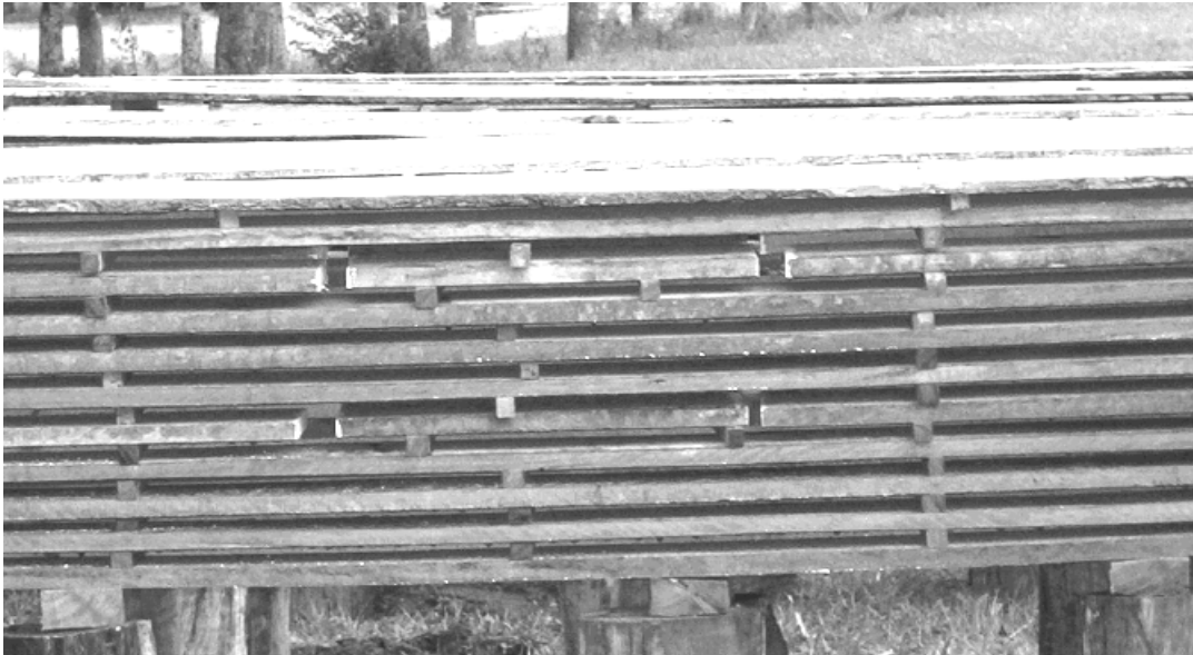
FIGURA 5: Posição das amostras de controle de secagem na pilha de madeira.
