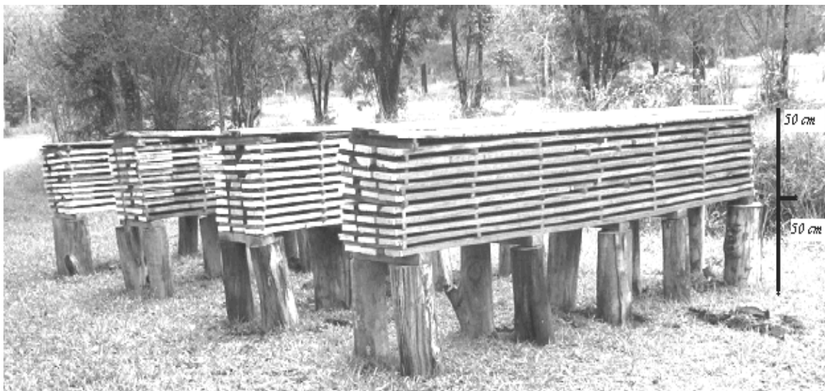
FIGURA 2: Empilhamento da madeira para secagem ao ar livre.
